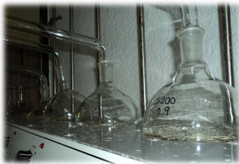
Figura 2.9 Destilación de las muestras de fenol
