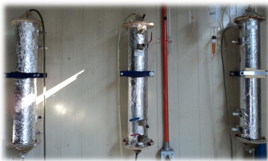
Figura 2.3 Biofiltros con volumen de 3.5 L
