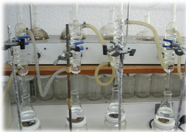
Figura 2.8 Montaje del sistema de destilación
