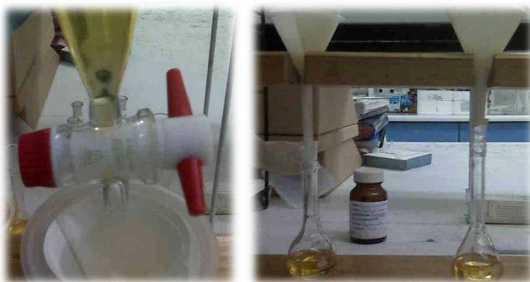
Figura 2.12 Filtración del extracto de cloroformo
