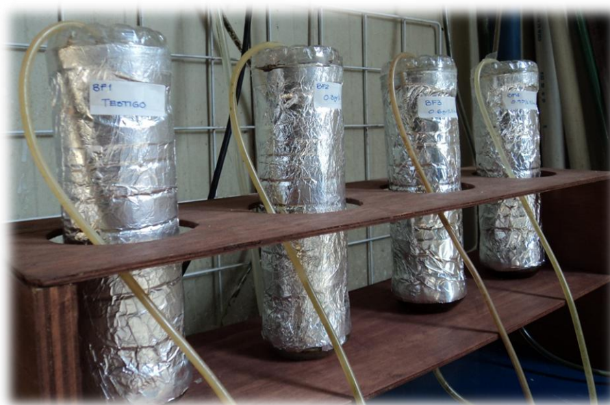
Figura 2.2 Biofiltros de volumen de 1 L
