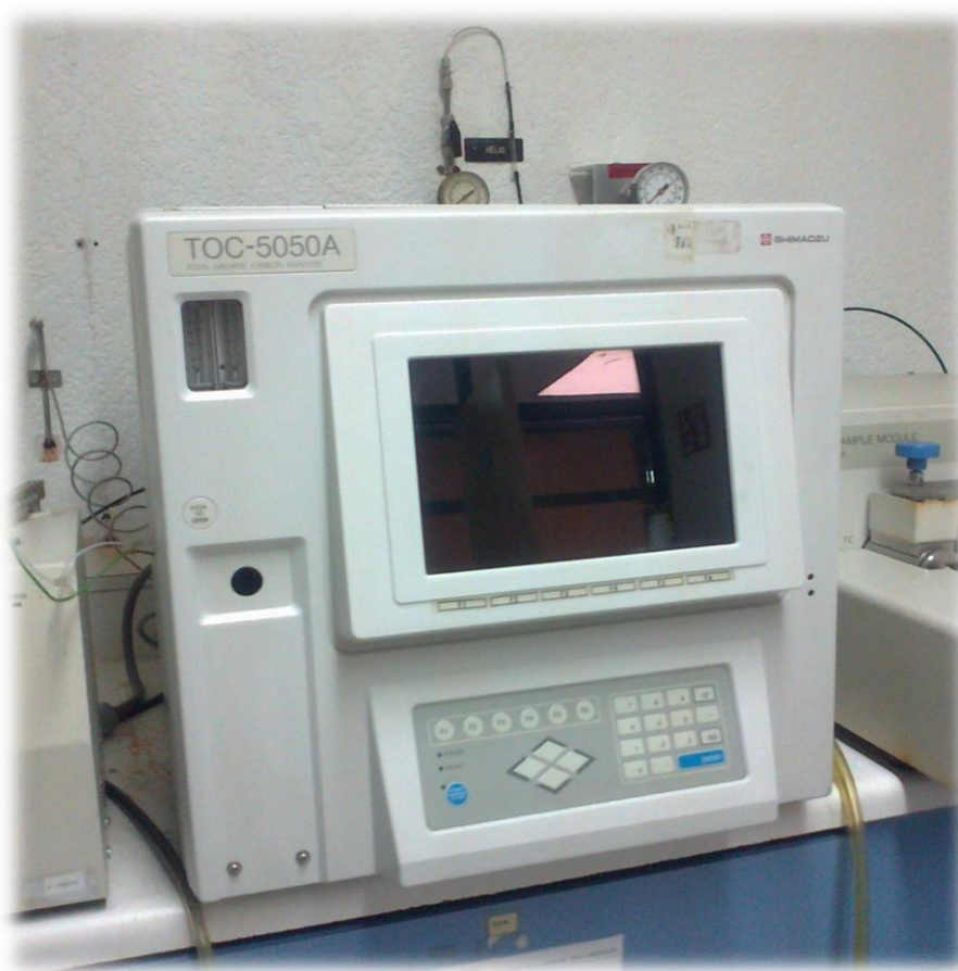
Figura 2.14 Equipo para la medición de COT
