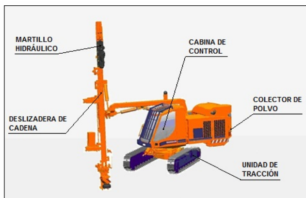
Figura 3.14 Perforadora hidráulica sobre orugas TAMROCK RANGER. [101] Sandvik.
