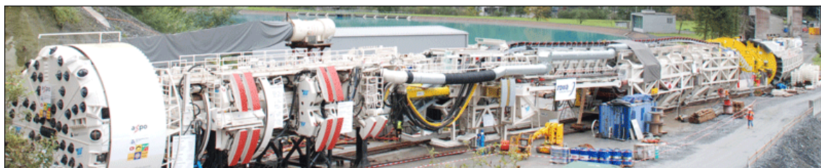
Figura 3.50 Tuneladora tipo topo de doble gripper utilizada en la construcción de un túnel para la planta hidroeléctrica Linthal en Suiza. En la foto se aprecia parte del equipo de apoyo. [100] Rowa Tunelling Logistics .
