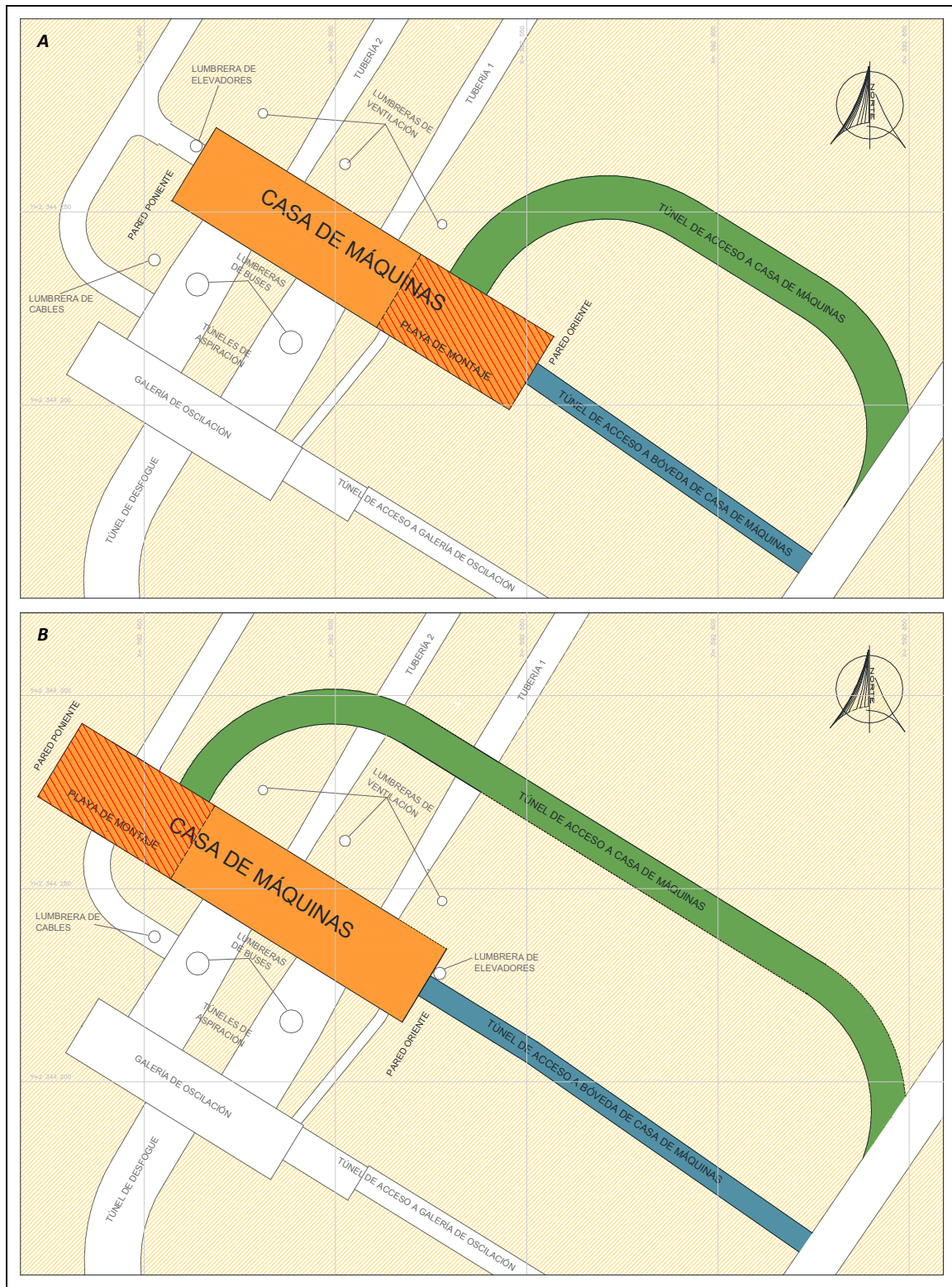
Figura 6.11 A. Ubicación original de la Casa de Máquinas, con la playa de montaje en el extremo oriente; B. Ubicación definitiva de la Casa de Máquinas, con la playa de montaje en el extremo poniente. El cambio en la posición de la playa de montaje hizo que la longitud de la caverna aumentara en 8.2 m (de 103.5 a 111.7 m), conservando la misma altura y el mismo ancho.
