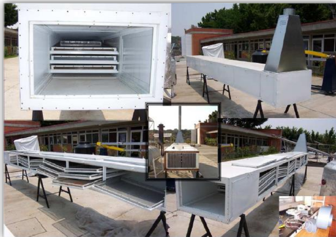
Fig. 2.7.- Secador de bandejas que trabaja con energía solar en el IER Temixco 2013 [IER].
