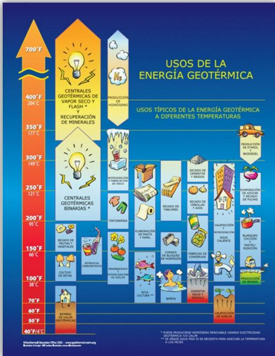
Fig. 1.13.- Principales usos de la energía geotérmica como una función de la temperatura (Trillo).
