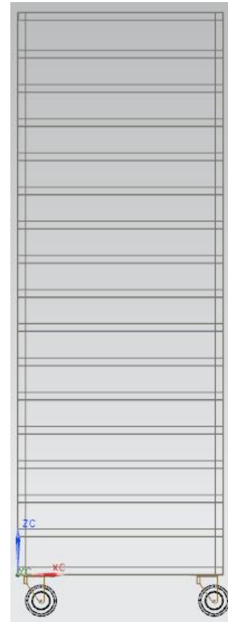
Fig. 4.5 Espiguero con charola para el deshidratado de alimentos; vista sólido y alambre respectivamente
