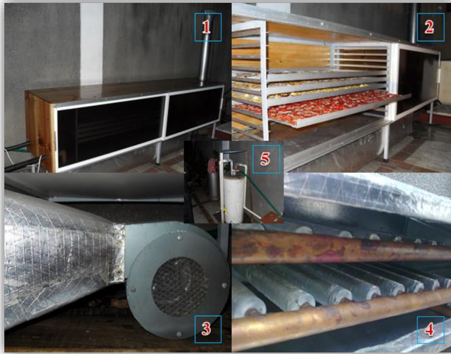
Fig. 3.3.- Deshidratador IMPULSA en funcionamiento; 1) Túnel de secado, 2) Charolas con producto (jitomate y manzana), 3) Soplador, 4) Serpentin calefactor, 5) Calentador de agua para simular el flujo geotérmico
