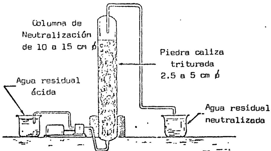
FIG. 1. Columnas de neutralización con piedra caliza.
