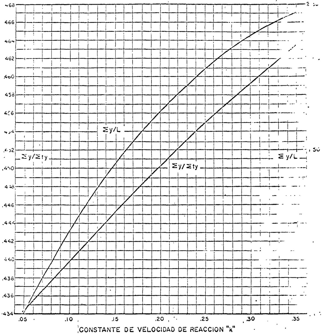
FIG. Valores de "k" y de la DBO última para series de pruebas de la DBO por 1, 2 y 3 días (según Moore, Thomas y Snow).
