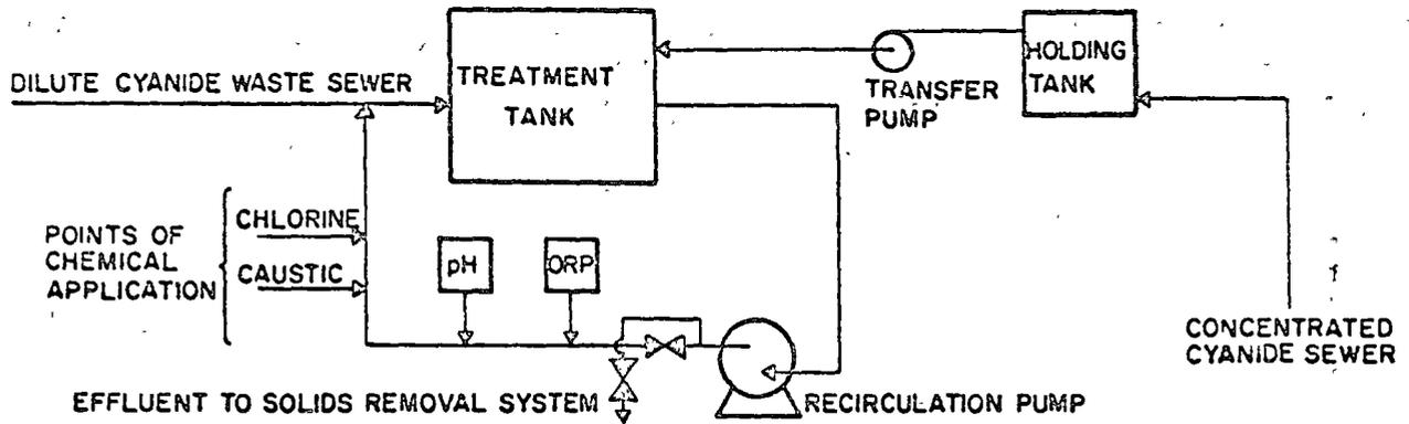
FIG. 1. SHOWN IS A TYPICAL SCHEMATIC DIAGRAM FOR A BATCH TYPE TREATMENT PROCESS FOR DESTROYING CYANIDE WASTES.
