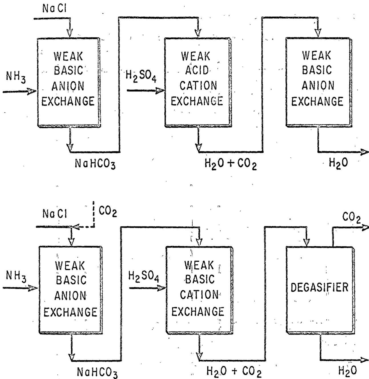
FIG. I. DESAL ION EXCHANGE PROCESS
