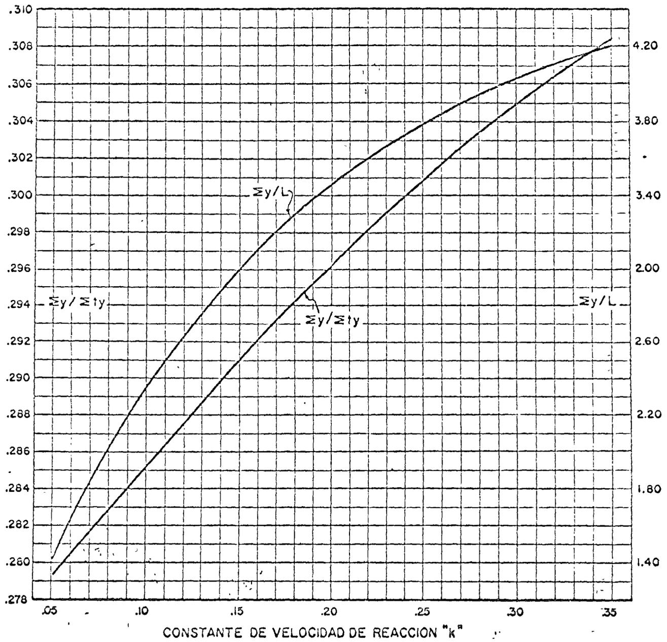
FIG. Valores de "k" y de la DBO última para series de pruebas de la DBO por 1, 2, 3, 4 y 5 días, (según Moore, Thomas y Snow).
