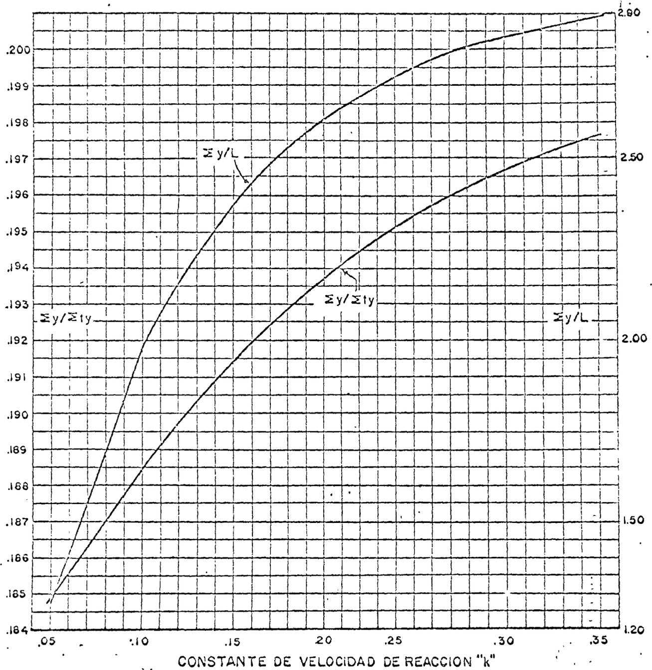
FIG. Valores de "k" y de la DBO última para series de pruebas de la DBO por 3,5 y 7 días (según Moore, Thomas y Snow).
