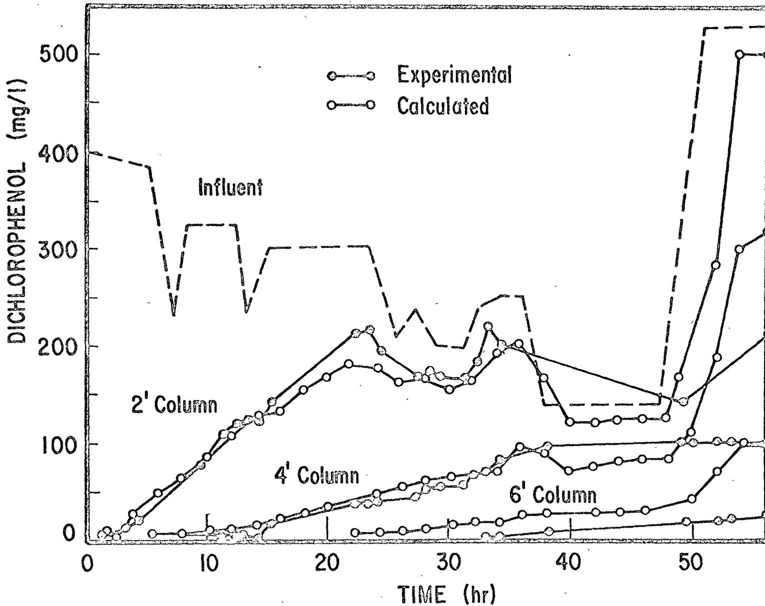
FIG. 6 - BREAKTROUGH CURVE COMPARISON
