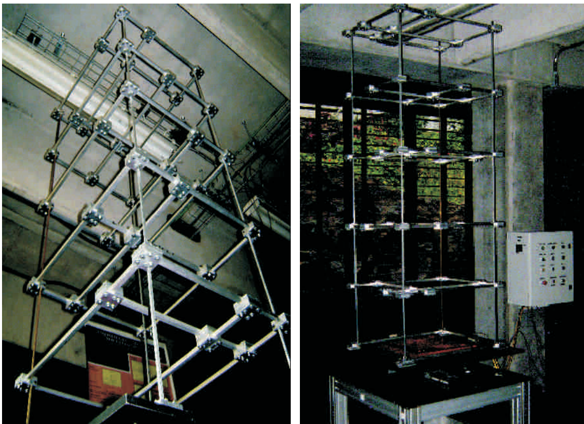
Figura 7.19: Modelo experimental de 5 pisos sobre la mesa vibradora
