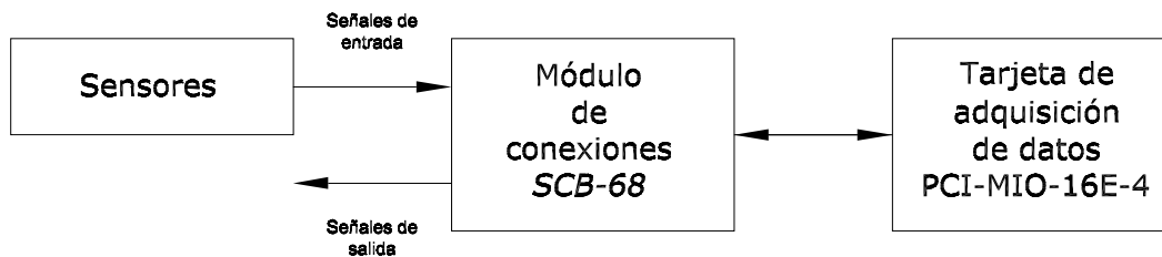
Figura F.1: Ruta de conexión entre los sensores y la tarjeta de adquisición de datos
