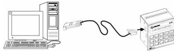
Figura 4.8: Cable de conexión.
