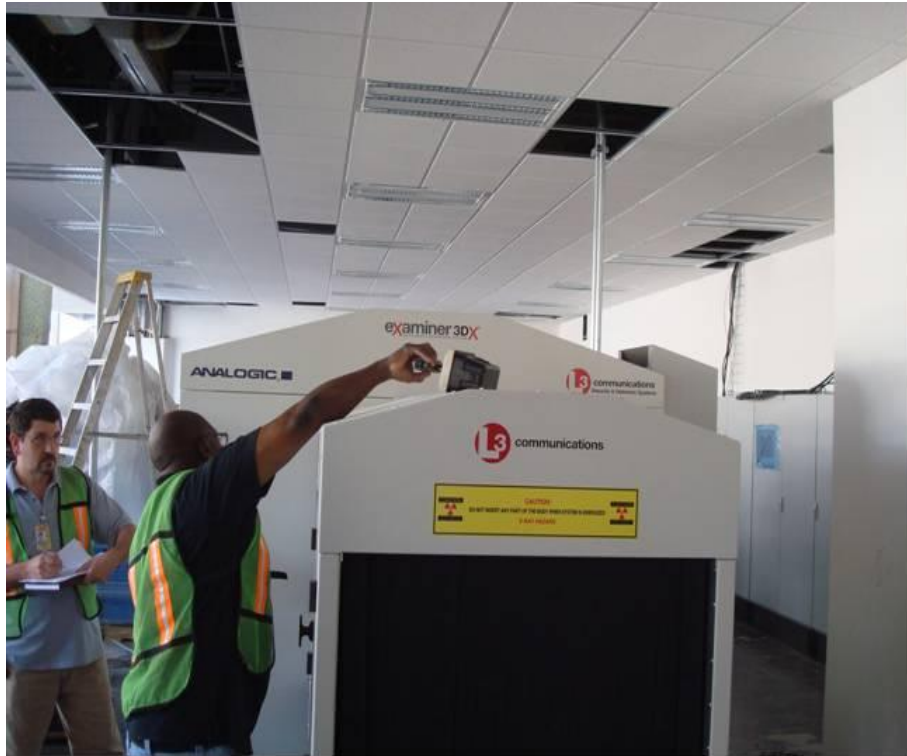
Figura 4.150. Muestra el proceso de realización de las pruebas de radiación al equipo tipo “eXaminer” (la realiza personal de la compañía que los fabrica) (Baselis, 2010)
