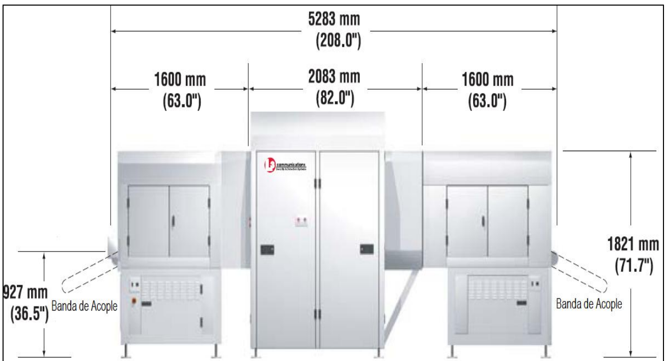
Figura 2.16. Especificaciones físicas a lo largo de la máquina scanner tipo EX – 3DX “eXaminer” (L3, 2010)
