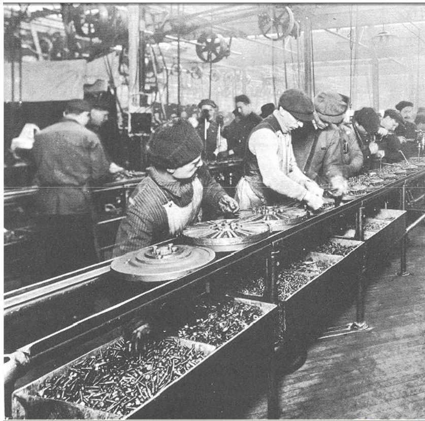
Figura 1.13. Fotografía de un sistema de bandas transportadoras en la Ford para el año de 1913 aplicadas al amarado de piezas (Hounshell, 1994)
