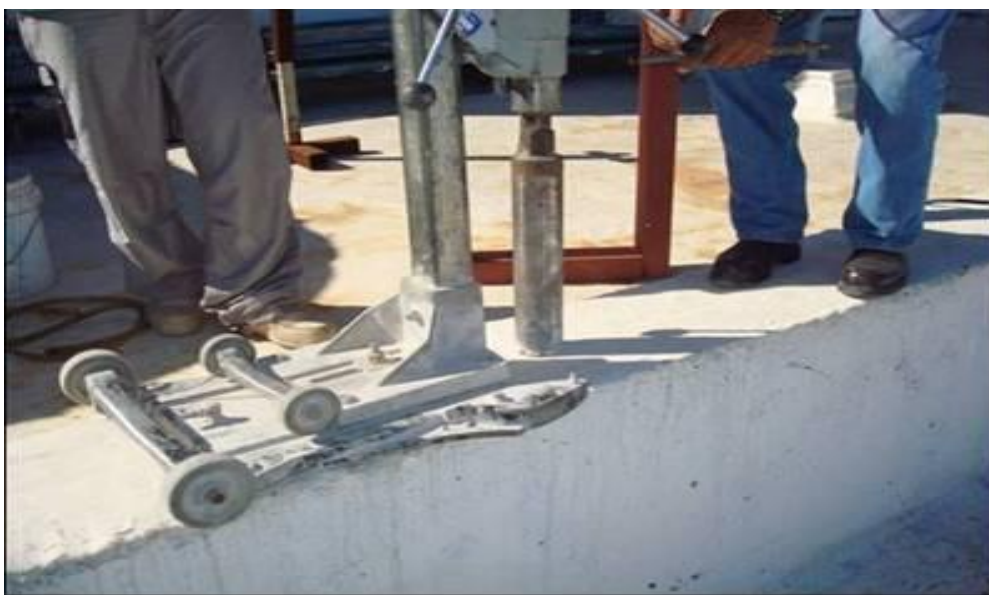
Figura 4.47. Proceso de pruebas en azotea para muestras de resistencia, mediante perforaciones aleatorias (Baselis, 2010)
