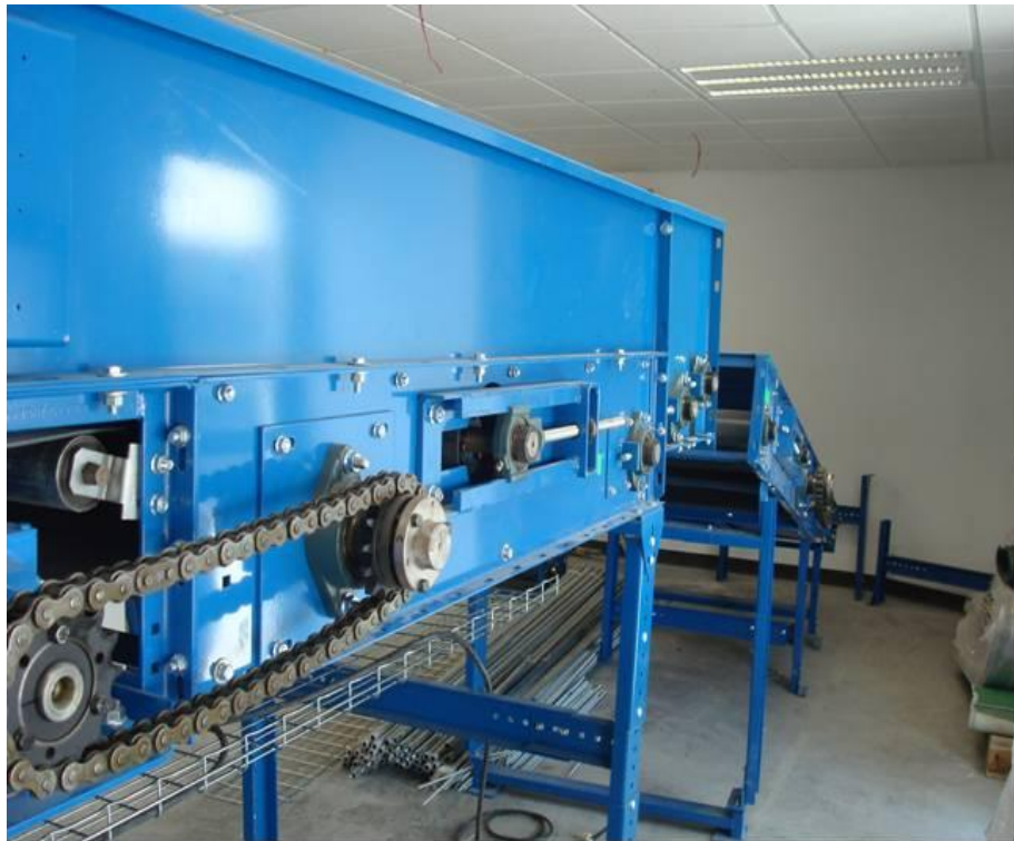
Figura 4.165. Engranajes y cadenas ensambladas a los motores individuales de cada módulo conformante del sistema de bandas transportadoras (Baselis, 2010)
