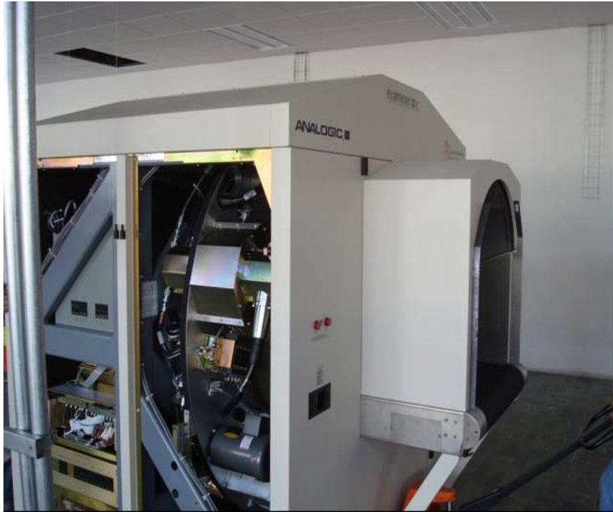
Figura 4.148. Muestra el equipo tipo “eXaminer” para el acomodo en su posición final (se ve su estructura interna) (Baselis, 2010)
