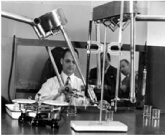
Figura 5. Primer Teleoperador Maestro-Eslavo Mecánico
