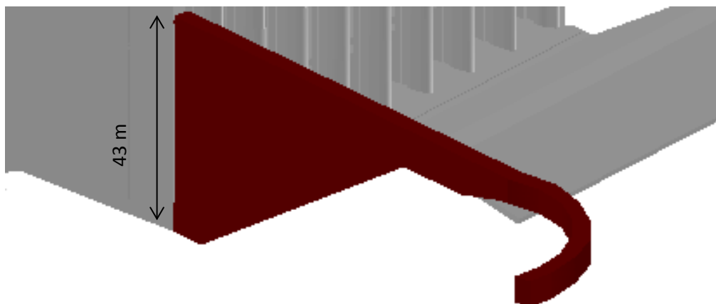
Figura 116.- Muro de encausamiento en desfogue
