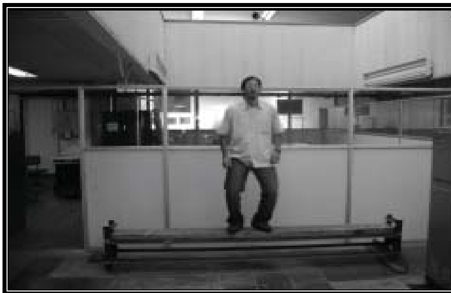
Figura 1.2.8 Persona generando impulsos sobre una viga.
