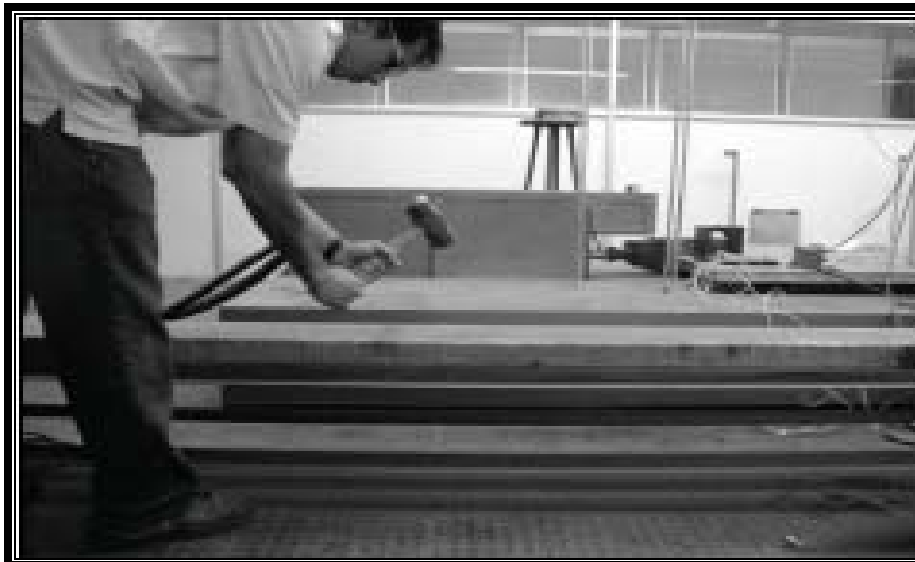
Figura 1.2.7 Golpe de martillo sobre viga.
