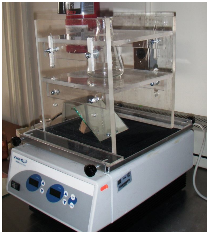
Figura 3.4: Imagen que muestra el montaje del matraz y el espejo sobre la maquina agitadora.
