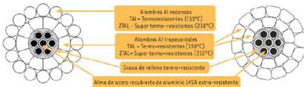
Figura 3.1. Construcción interna de algunos conductores HTLS.
