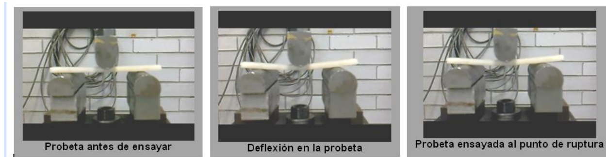
Figura 3.15. Ensayo de flexión en cementos óseos reforzados con HA.
