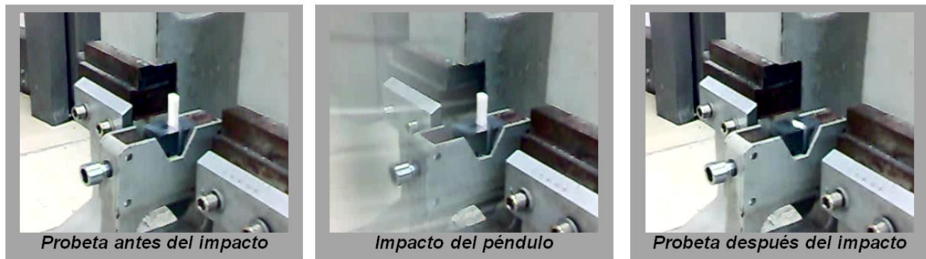
Figura 3.19. Ensayo de resistencia al impacto izod en cementos óseos reforzados con HA.
