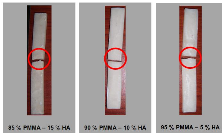
Figura 3.18. Fracturas de tipo frágil en probetas de flexión.
