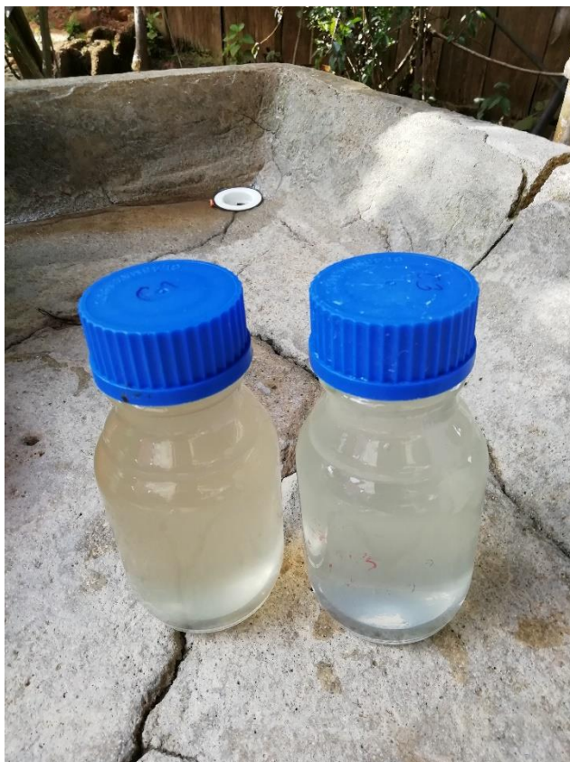
Figura 4.6 Comparativa visual entre el agua cruda (Izq.) y el agua tratada (Der.) del filtro de Don Tumín (Elaboración propia, 2019)
