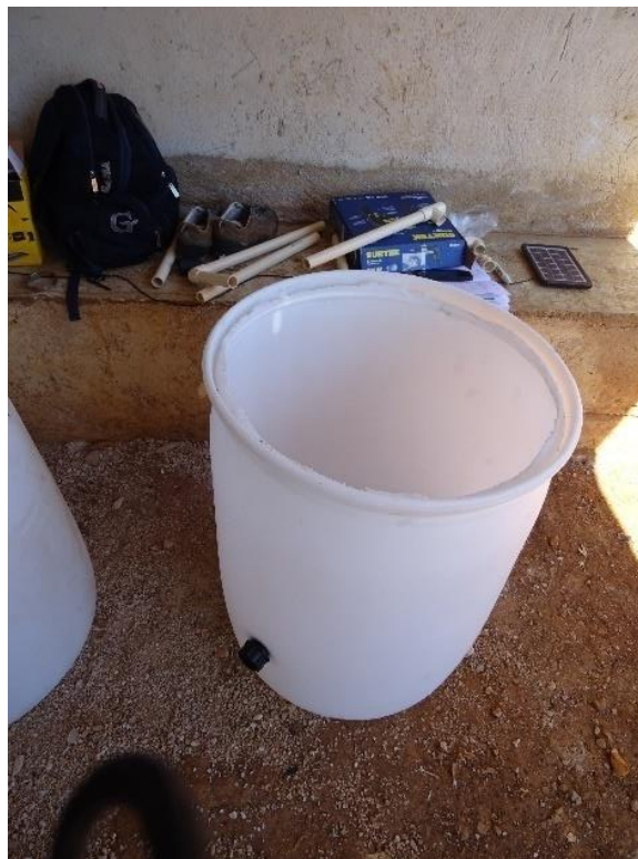
Figura 3.14 Tambo perforado con brida (Elaboración propia, 2019)
