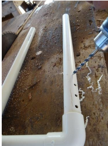
Figura 3.17 Perforación de orificios en la estructura con forma de <<U>> (Elaboración propia, 2019)
