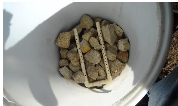
Figura 3.21 Estructura en forma de u posada sobre la capa de rocas (Elaboración propia, 2019)
