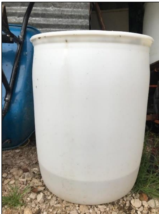
Figura 3.10 Tambo utilizado de PEAD de 140 litros (Elaboración propia, 2019)
