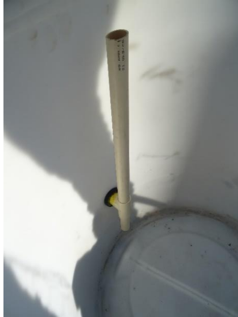
Figura 3.15 Tambo con t y tubos de CPC para separación por densidad (Elaboración propia, 2019)
