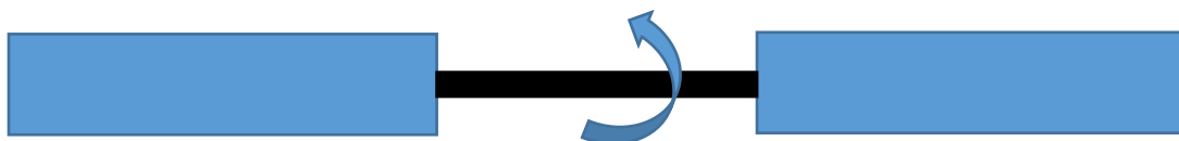
Figura 40 - Esquema simplificado del mecanismo de rotación, se muestran el eje del motor en negro (eje de rotación) y el arreglo de paneles solares en azul [Vista superior].
