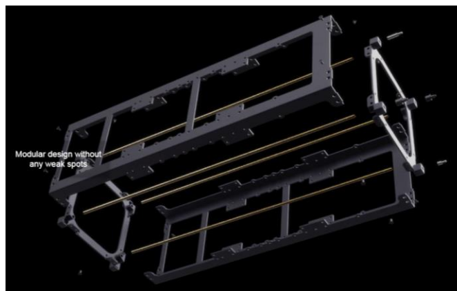
Figura 14 - Plano en explosión de la estructura para CubeSat 3U de ENDUROSAT [19].
