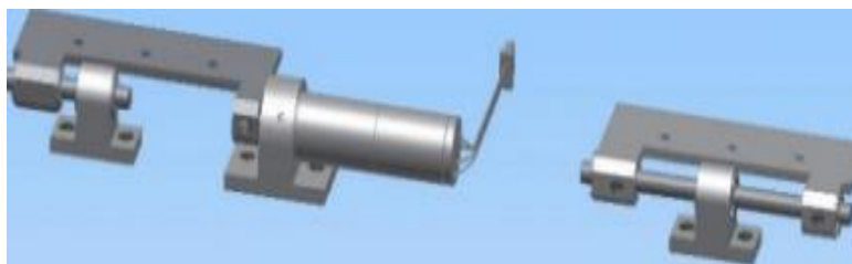
Figura 18 - Mecanismo de despliegue de paneles solares basado en un motor a pasos [22].
