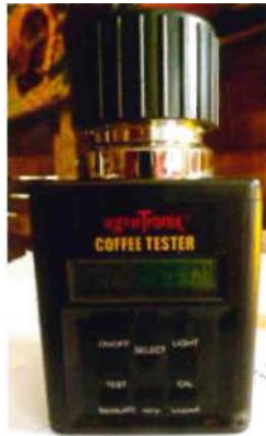
Figura 3. Higrómetro utilizado para medir la humedad del café. (Caballero Pérez Juan Francisco, 2015).
