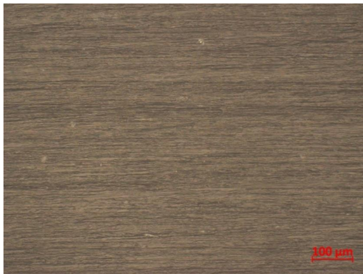
Figura 3.2 Fotografía de la superficie tomada en 20x con el microscopio óptico, en la cual se distingue homogeneidad en las líneas de lijado.
