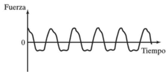
Figura 2-1 Representación de una vibración determinística periódica.
