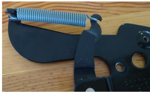
Figura 3-3 Colocación del resorte en la bisagra.
