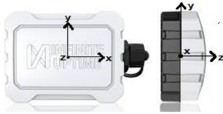
Figura 3-13 Sistema de referencia que posee el acelerómetro.
