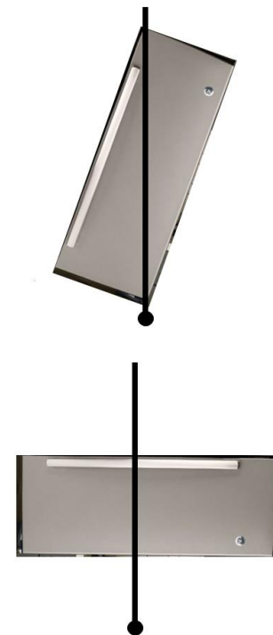
Figura 3-10 Obtención del centroide de la puerta del refrigerador.
