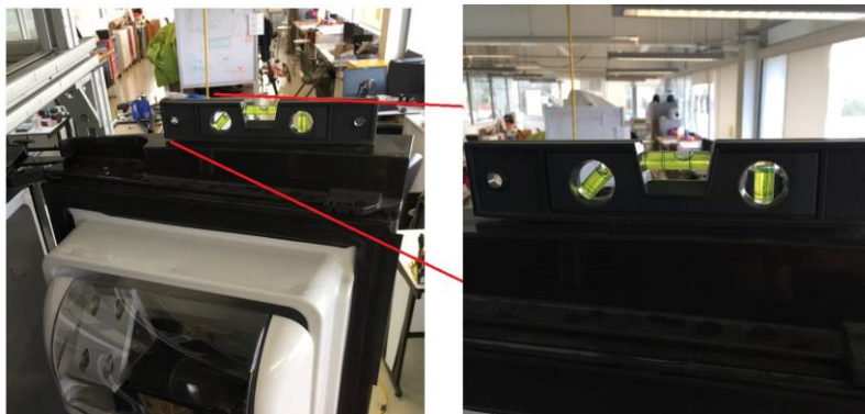
Figura 3-23 Apreciación de la puerta ladeada.
