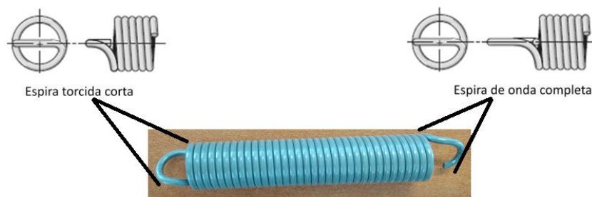
Figura 3-2 Identificación de las espiras del resorte de la bisagra.
