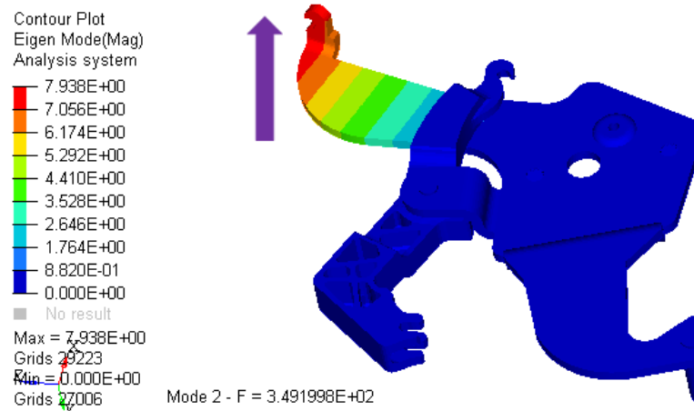
Figura 4-3 "Modo de vibrar de la bisagra a la frecuencia de 349 Hz".
