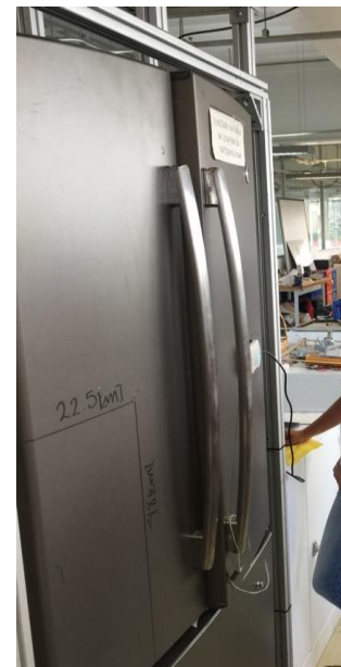
Figura 3-22 Resultado de la puerta después del impacto.
