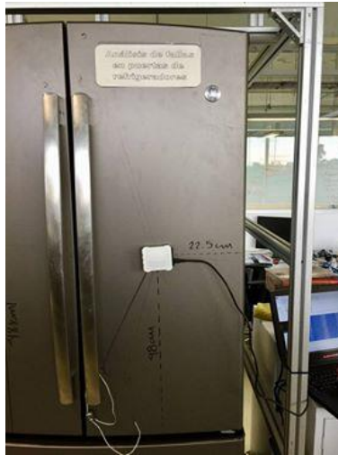
Figura 3-12 Colocación del acelerómetro.
