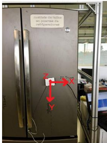
Figura 3-14 Colocación del sensor sobre la puerta del refrigerador.
