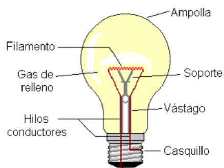
Imagen 2.2) Componentes de una lámpara incandescente no halógena Fuente: Catálogo de lámparas PHILIPS
