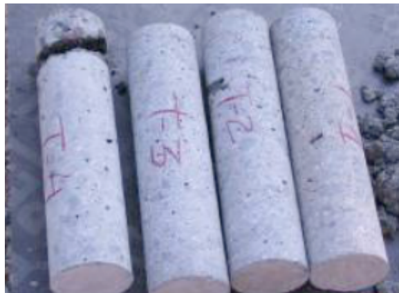
Imagen 18 .- Pruebas mecánicas del concreto.
