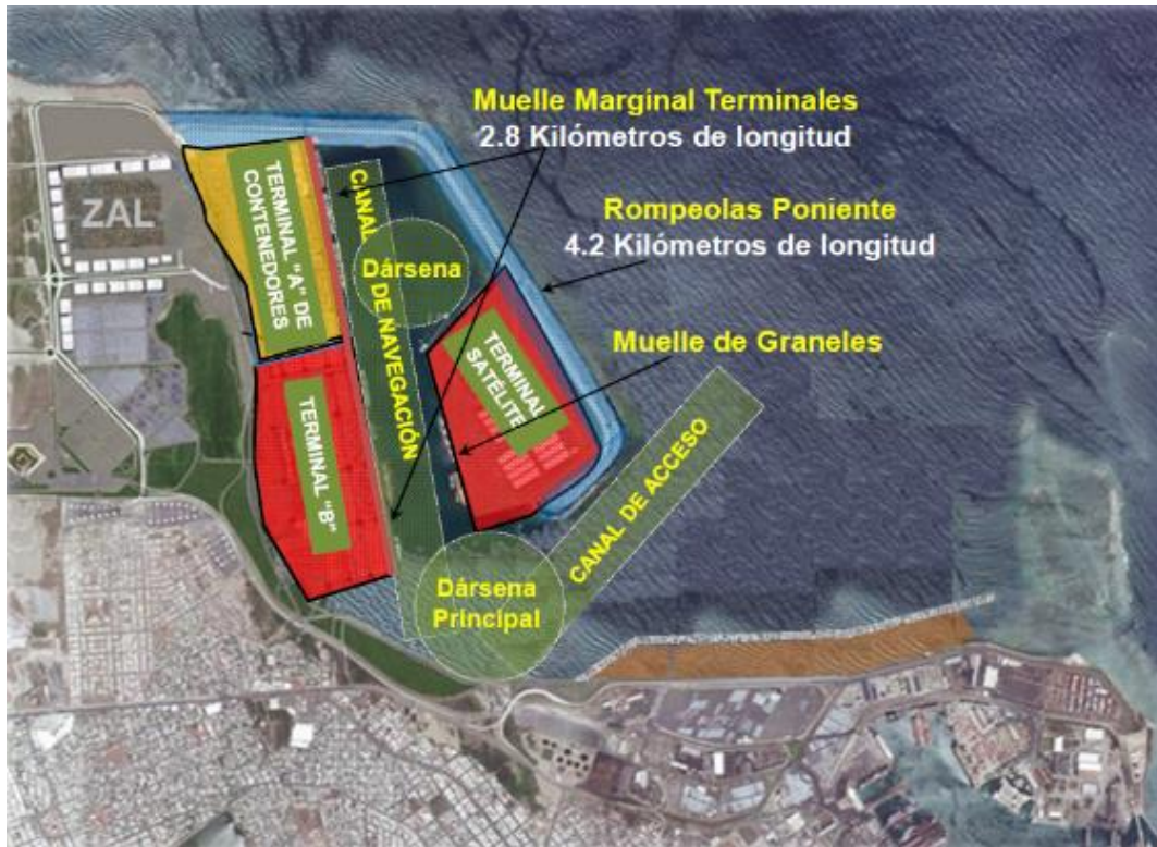
Figura 5. 2. 11. Arreglo del Puerto en primera etapa
