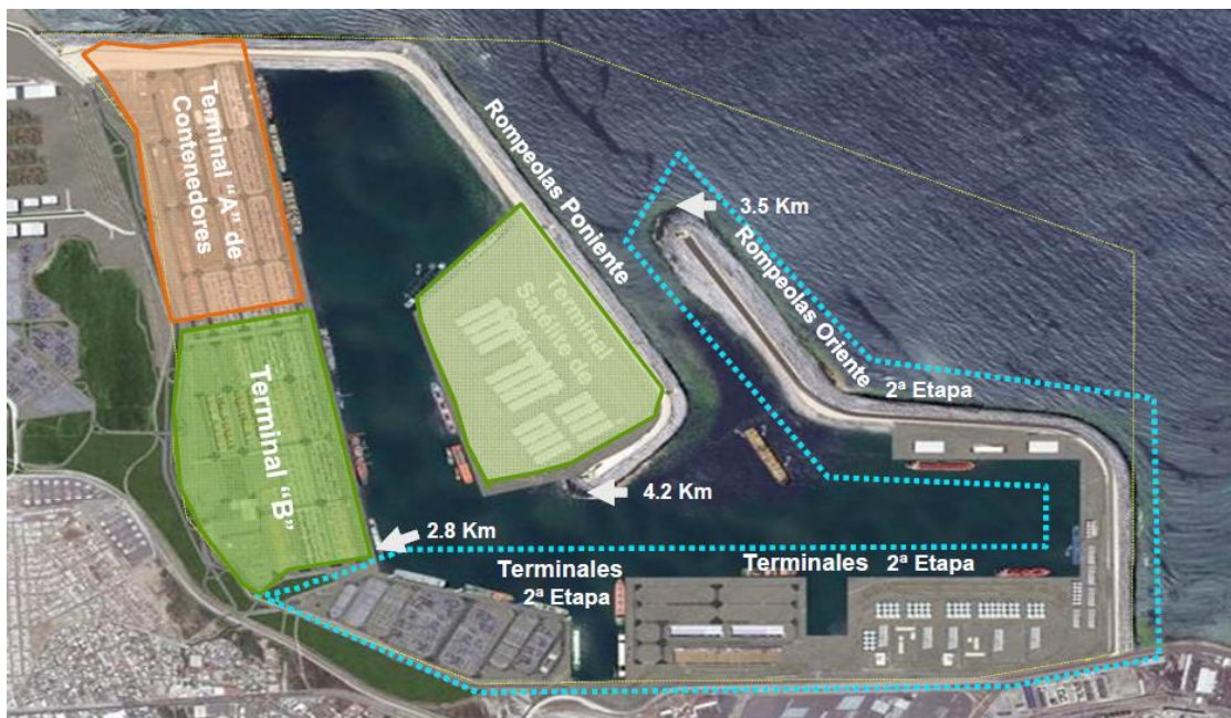
Figura 5. 2. 12. Arreglo del puerto en segunda etapa
