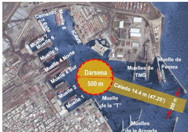
Figura 5. 2. 7. Geometría interna del Puerto
