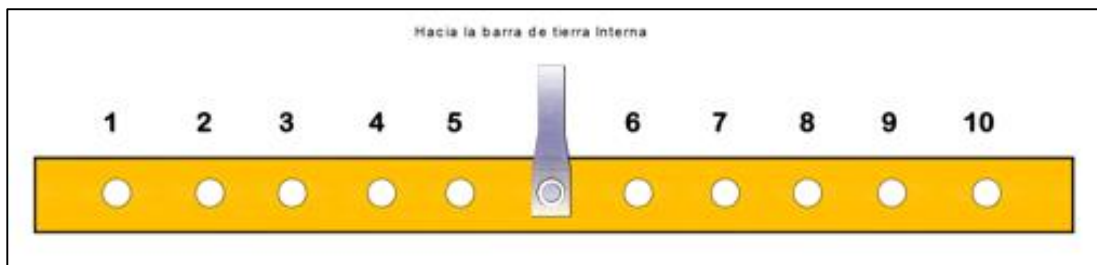
Figura B 30. Posición de cable verde 2 AWG en barra de tierra de Rack de 19". [M 9]
