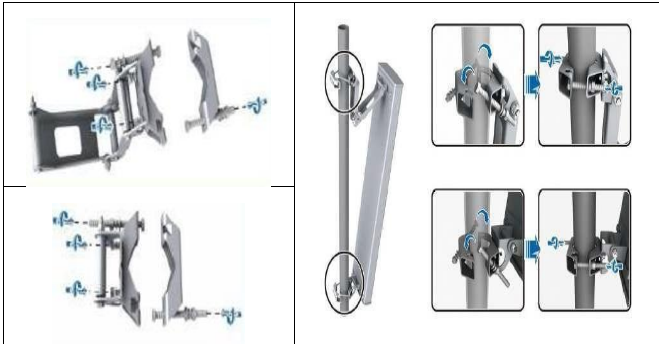
Figura B 65. Instalación de antena en mástil. [M 9]
