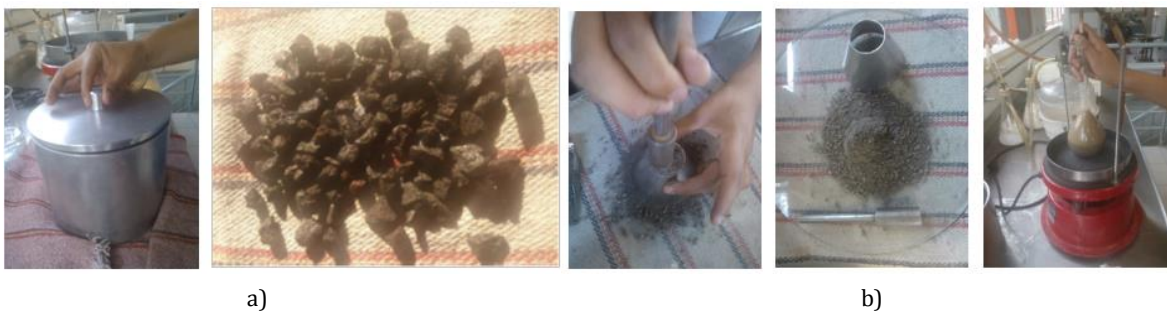
Fig. 2-27 Determinación de la gravedad específica; a) Fracción retenida malla No 4, b) Fracción que pasa malla No 4 (Josephia, R., 2015)
