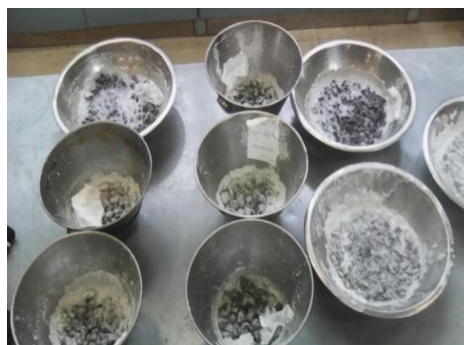
Fig. 2-26 Agregado con solución de sulfato de sodio (Garcia Salas, 2014)
