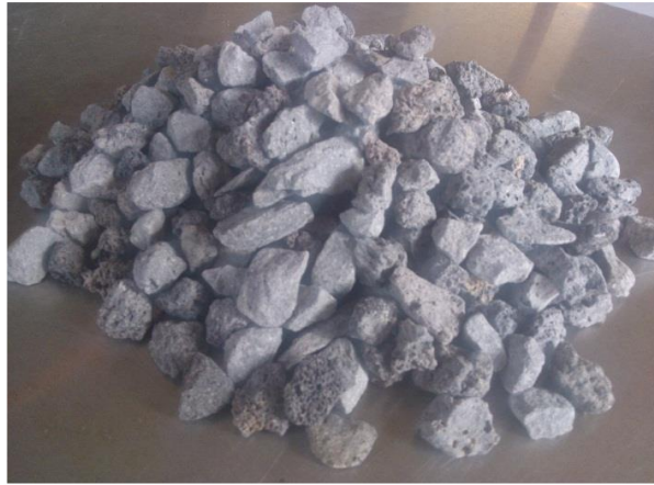
Fig. 2-21 Caras fracturadas del agregado grueso
