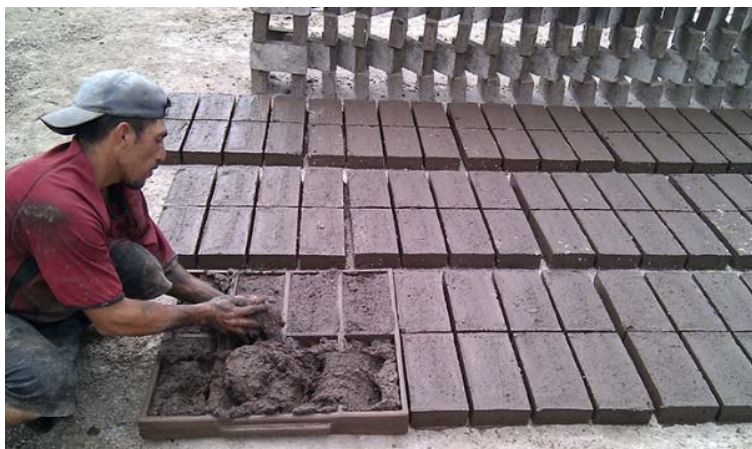
Figura 47. Extrusión de ecoladrillos de adobe
