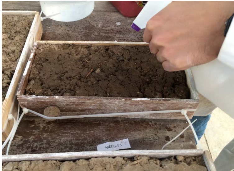
Figura 92. Humedecimiento de la superficie del ladrillo
