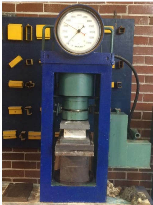
Figura 97. Colocación de ladrillo para prueba de compresión
