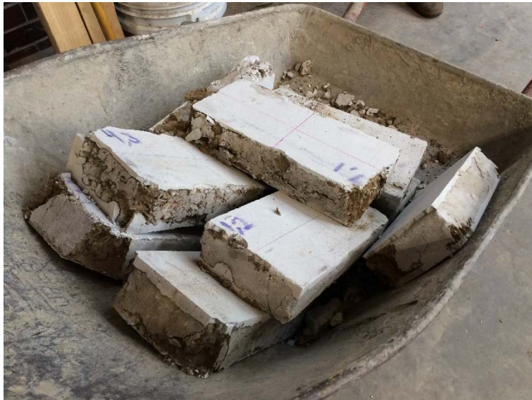
Figura 101. Ladrillos probados manteniendo su estructura
