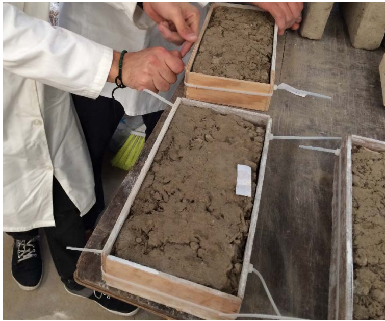
Figura 90. Encofrado de ladrillos para cabeceo
