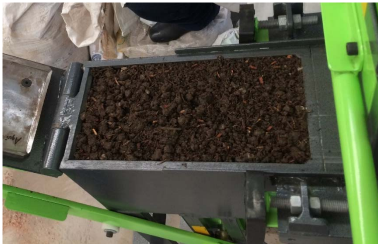
Figura 111. Material dispuesto en la cámara de prensado
