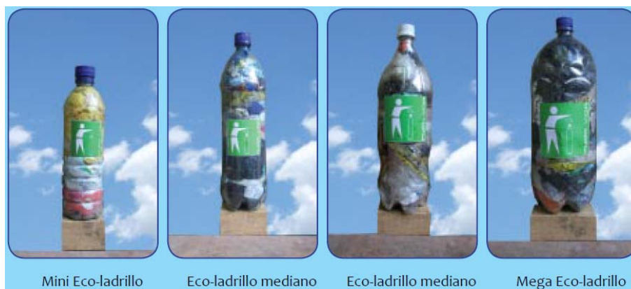
Figura 44. Ecoladrillos a base de botellas PET rellenas de residuos
