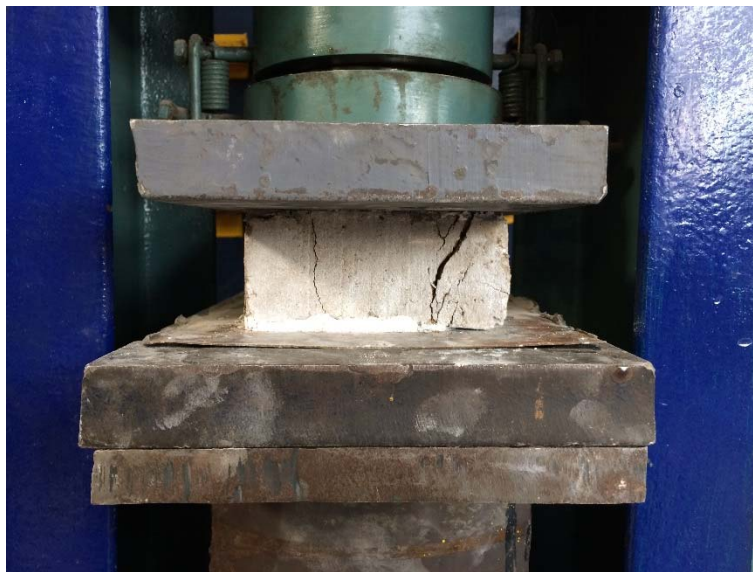
Figura 99. Presentación de la falla en el ladrillo
