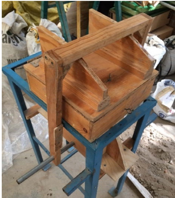
Figura 80. Prensado de la mezcla
