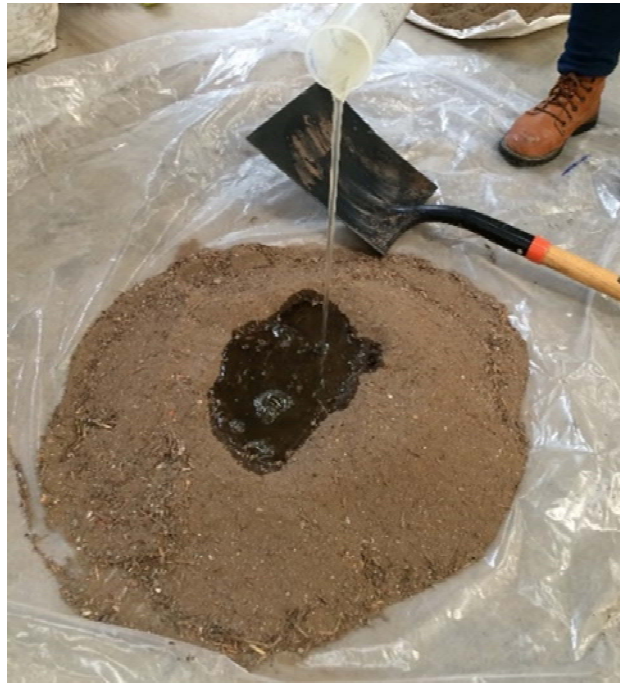
Figura 76. Vertido de mucílago a la mezcla
