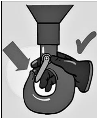
Figura 4.6.1.4. Verificación del pestillo de seguridad.
