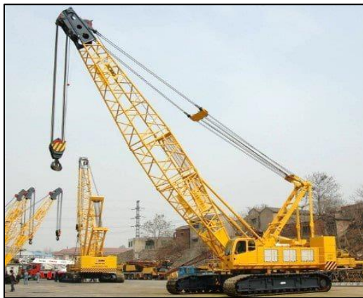
Figura 3.5. Grúa sobre orugas. Fuente: www.norman-spencer.com
