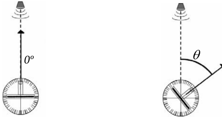
(a) Señal arribando desde el Broadside. (b) Señal arribando desde la dirección \theta .
