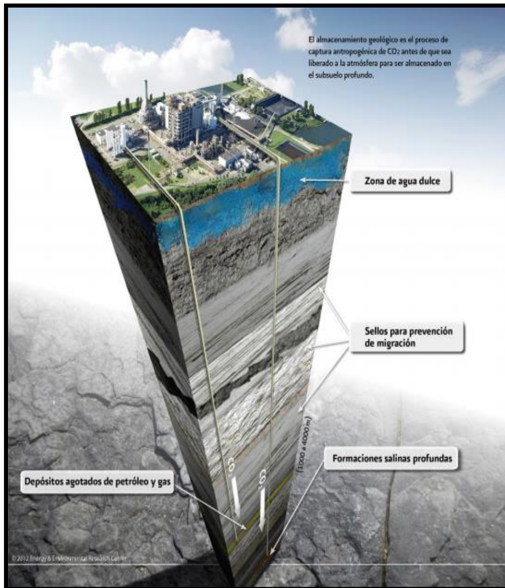
Figura 4.2. Representación gráfica del almacenamiento geológico de CO 2 (SENER, 2012).
