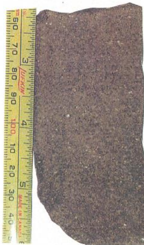
Figura 14.- Vista macroscópica de fragmento de núcleo (Pozo: Ku-401) ilustrando una calcarenita grainstone impregnada de aceite. Observaciones macroscópicas del núcleo indican laminaciones altamente planares, buzadas ligeramente, resultados de una alineación de tipos de grano tabulares. De otra forma la roca no tiene características peculiares homogéneamente.
