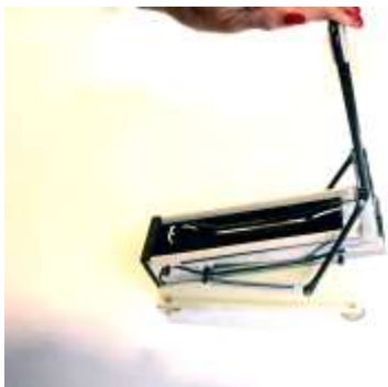
Figura 3.4. Se baja la palanca con la mano. La palanca a su vez mueve a los brazos y éstos mueven al rodillo para empezar a enrollar la hoja de parra
