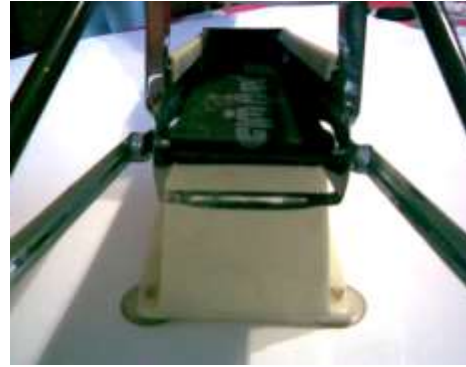
Figura 3.13. Este es el único momento en el que la banda se tensiona debido a que como los ejes que sujetan a la banda se encuentran fijos y el rodillo al llegar al final de la guía estira la banda
