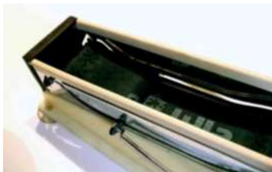
Figura 3.7. En esta toma se puede observar cómo el rodillo queda unos milímetros por encima del resto de la banda
