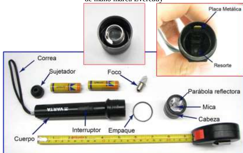
Figura 2.10. Explosivo para mostrar todas las partes que componen una linterna de mano marca Varta
