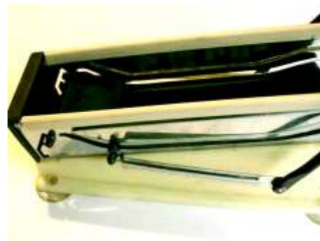
Figura 3.5. Por la primer pendiente que tiene la guía, el rodillo hace que el extremo de la hoja de parra (recargada en la banda) libere la comida al aproximarla con el resto de la hoja.
