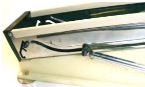
Figura 3.6. Se sigue jalando la palanca y en este momento forma una "C" ligeramente cerrada.
