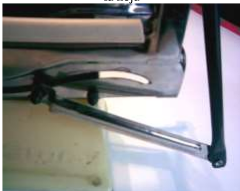
Figura 3.10. Esta ligera curvatura que presenta la guía es para que el rodillo libre al eje donde está fijo el otro extremo de la banda
