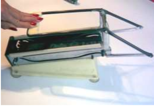
Figura 3.12. Cuando el rodillo llega al final de la guía, el rollo de hoja es expulsado
