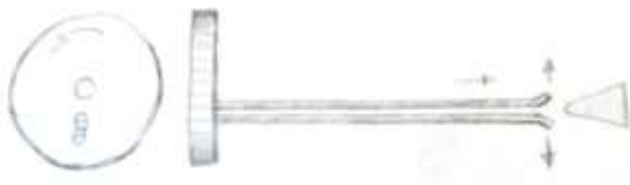
Figura 6.3. Pinzas del enrollador montadas en disco de plástico para proporcionar giro excéntrico
