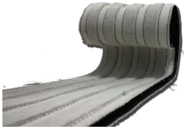
Figura 6.14. Prospecto de banda con costillas
