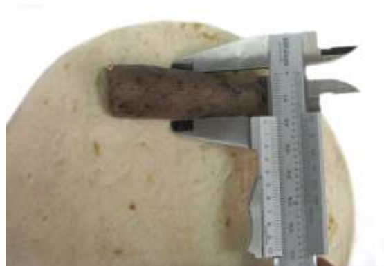
Figura 8.3. Medición del diámetro del relleno
