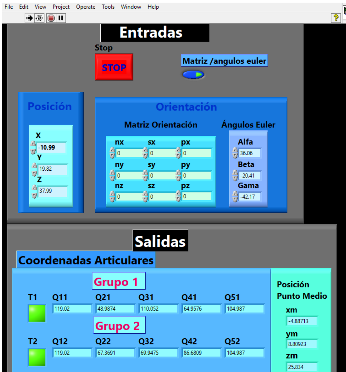
Figura 108 Datos de entrada y salida para la cinemática inversa de la primera prueba.
