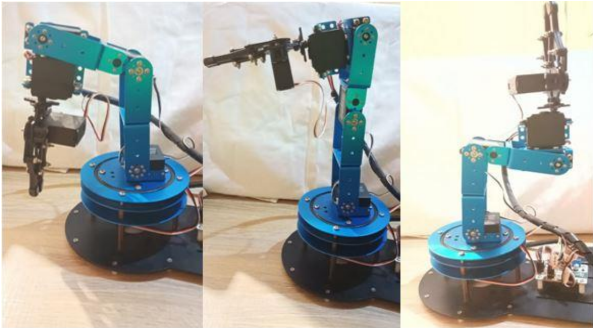
Figura 17 Rango de movimiento del tercer grado de libertad.
