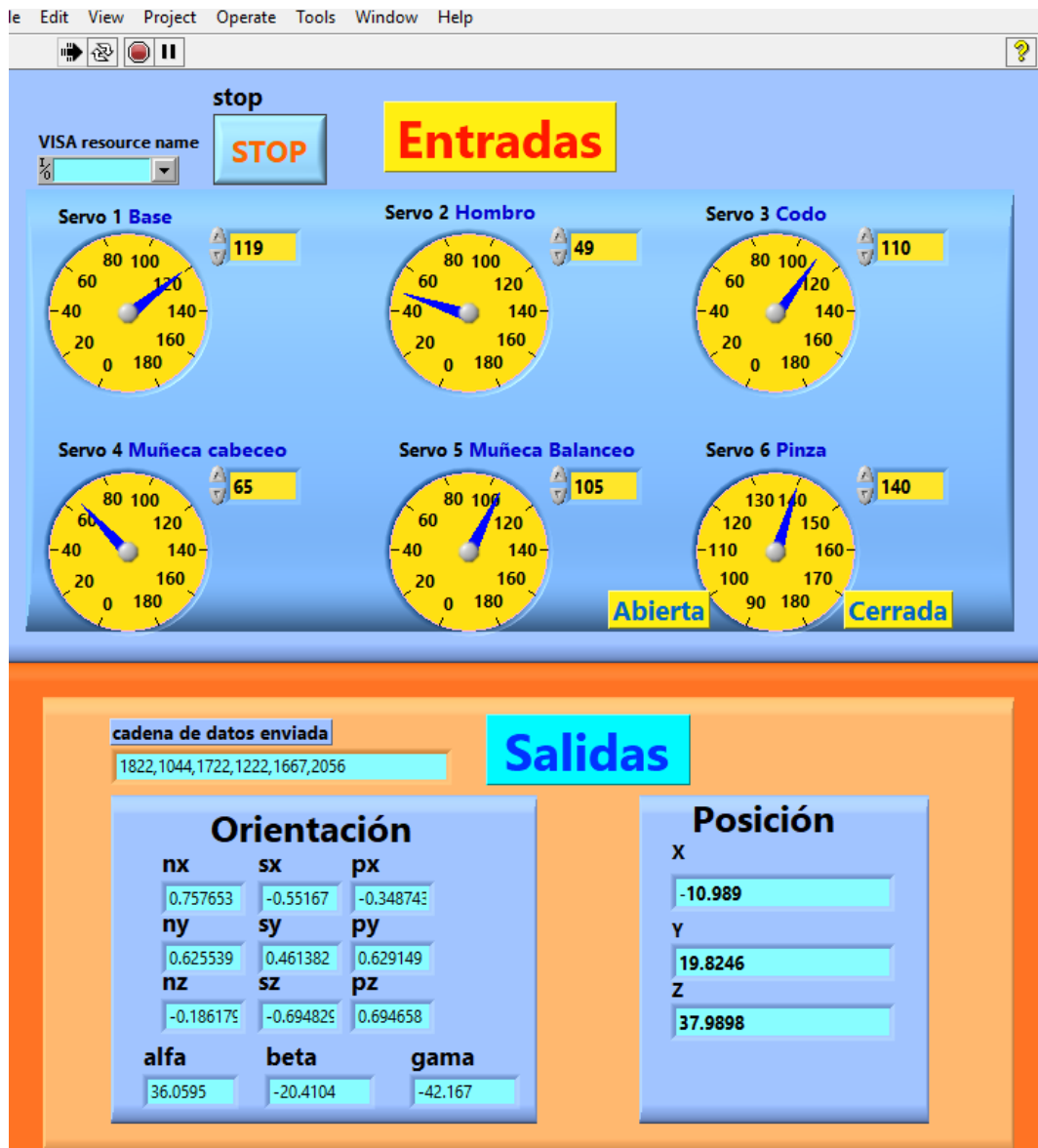
Figura 107 Datos ingresados en la cinemática directa y sus respectivos datos de salida (primera prueba).
