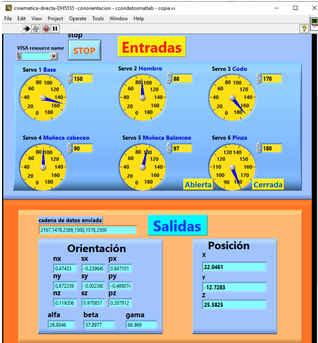
Figura 98 Panel frontal del programa de cinemática directa con los datos ingresados y los obtenidos para la segunda prueba.
