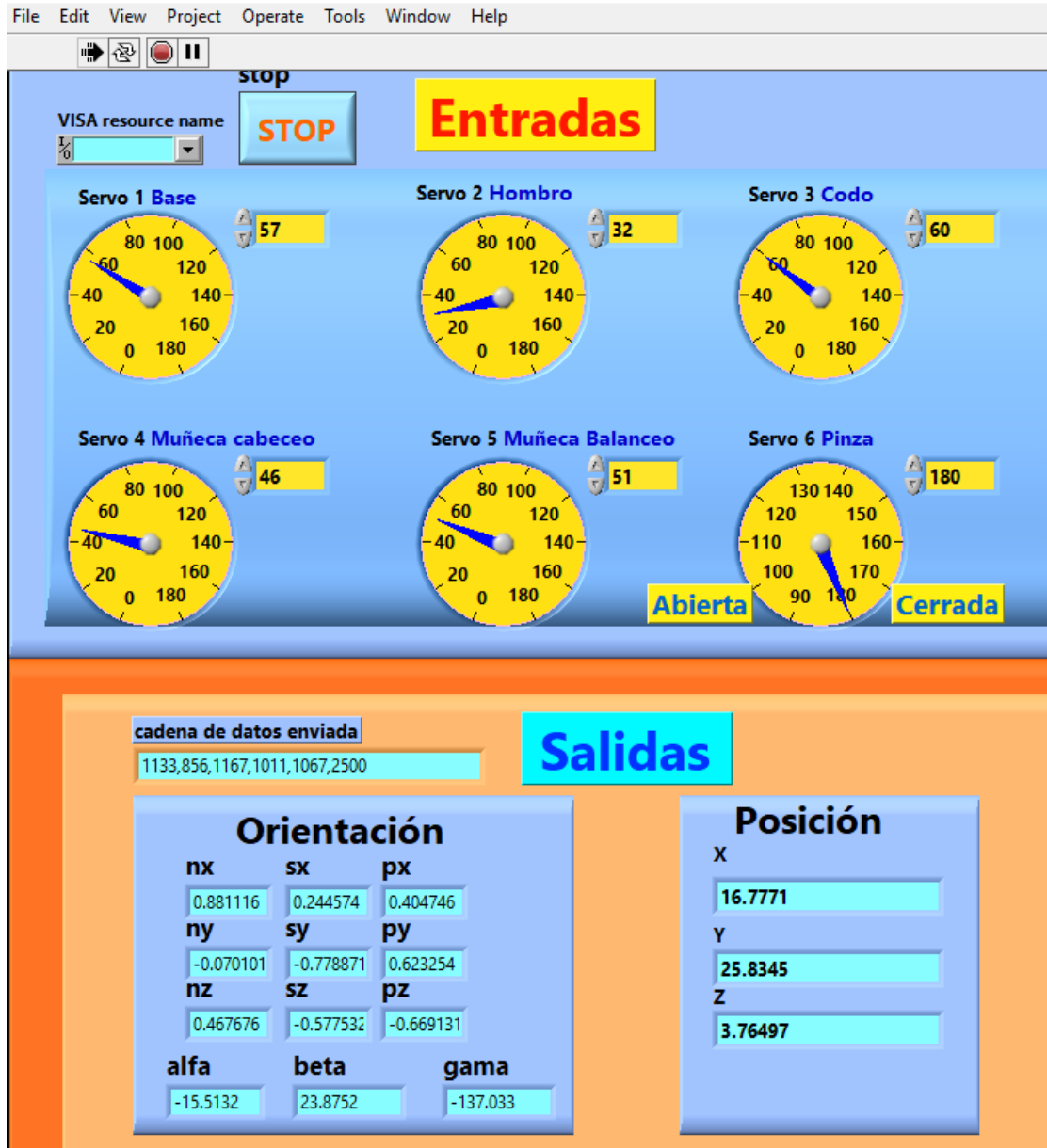
Figura 95 Panel frontal del programa de cinemática directa con los datos ingresados y los obtenidos para la primera prueba.
