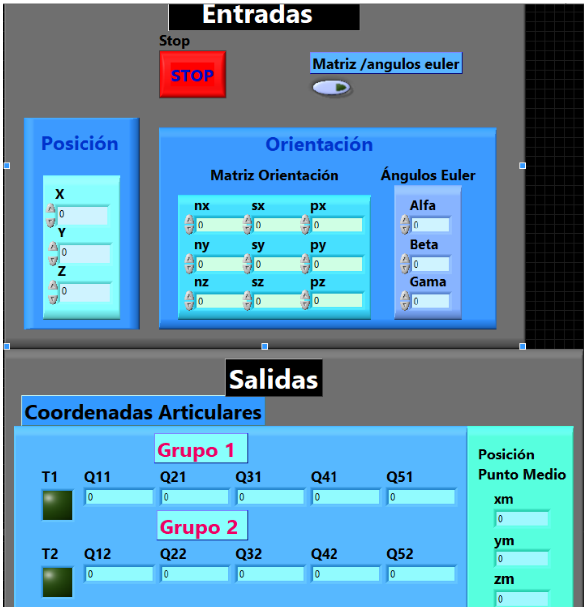
Figura 82 Panel frontal del Programa para la implementación de la cinemática inversa.
