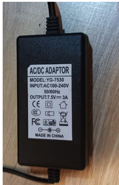
Figura 24 Adaptador de 7.5 volts que permite alimentar con corriente a los servomotores del robot LeArm.
