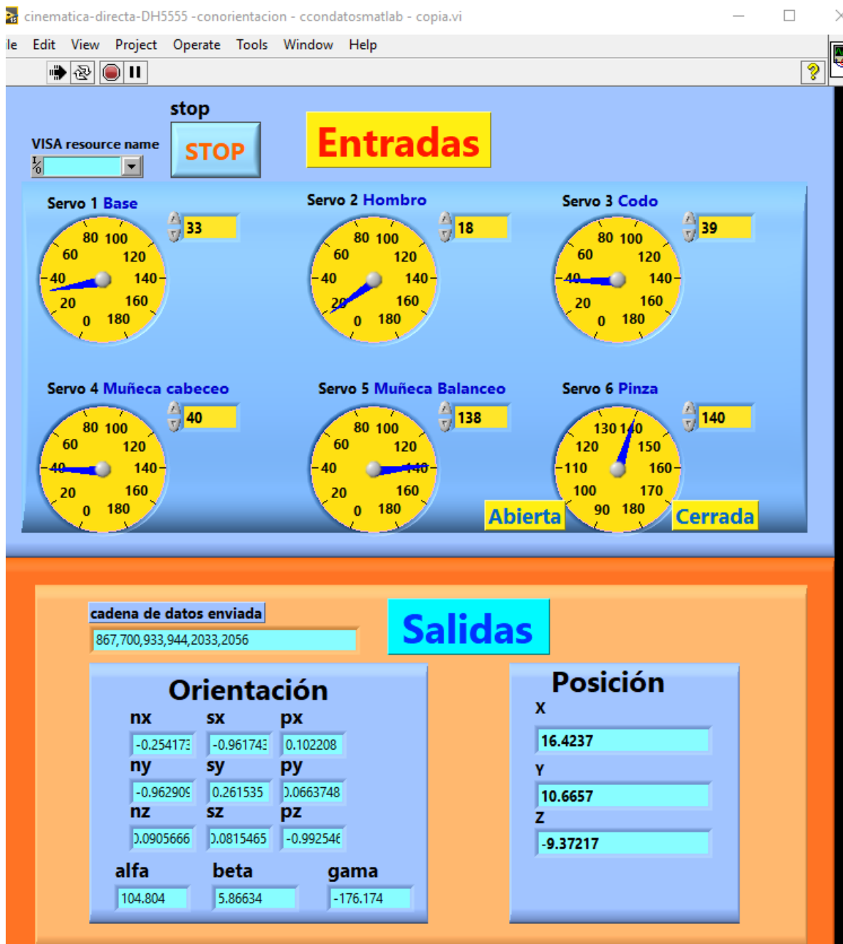
Figura 110 Datos ingresados en la cinemática directa y sus respectivos datos de salida (segunda prueba).
