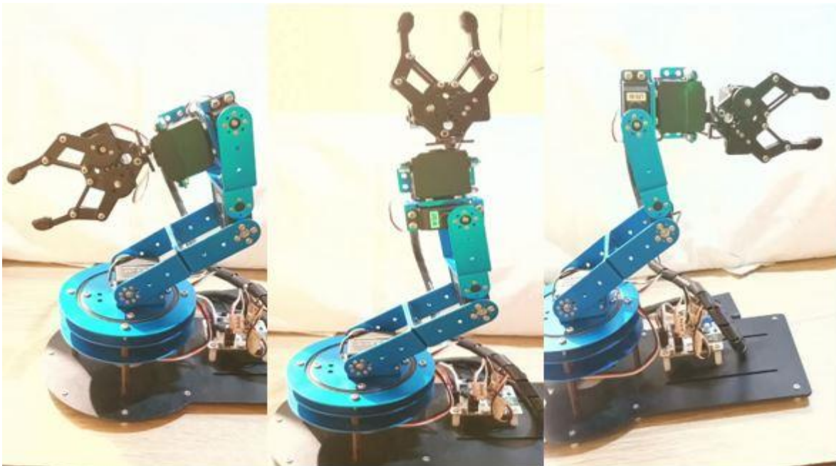
Figura 18 Rango de movimiento del cuarto grado de libertad.
