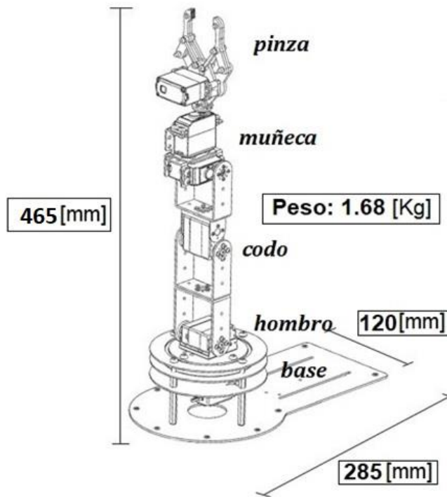
Figura 11 Medidas de la base y altura en una configuración vertical del robot.
