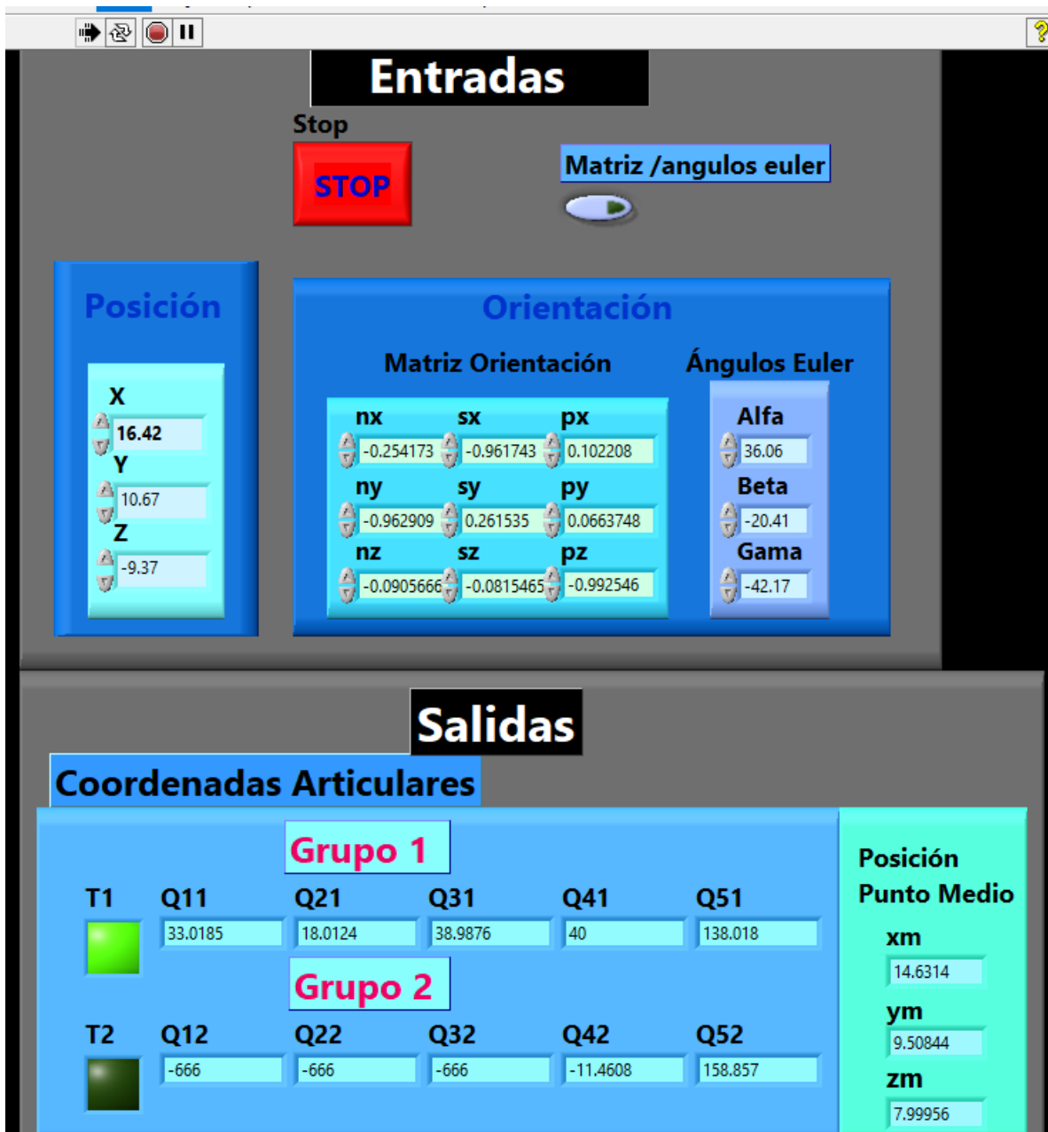
Figura 111 Datos de entrada y salida para la cinemática inversa de la segunda prueba.
