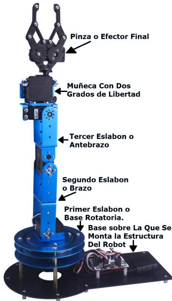
Figura 10 partes que componen al robot manipulador LeArm de 5 grados de libertad.
