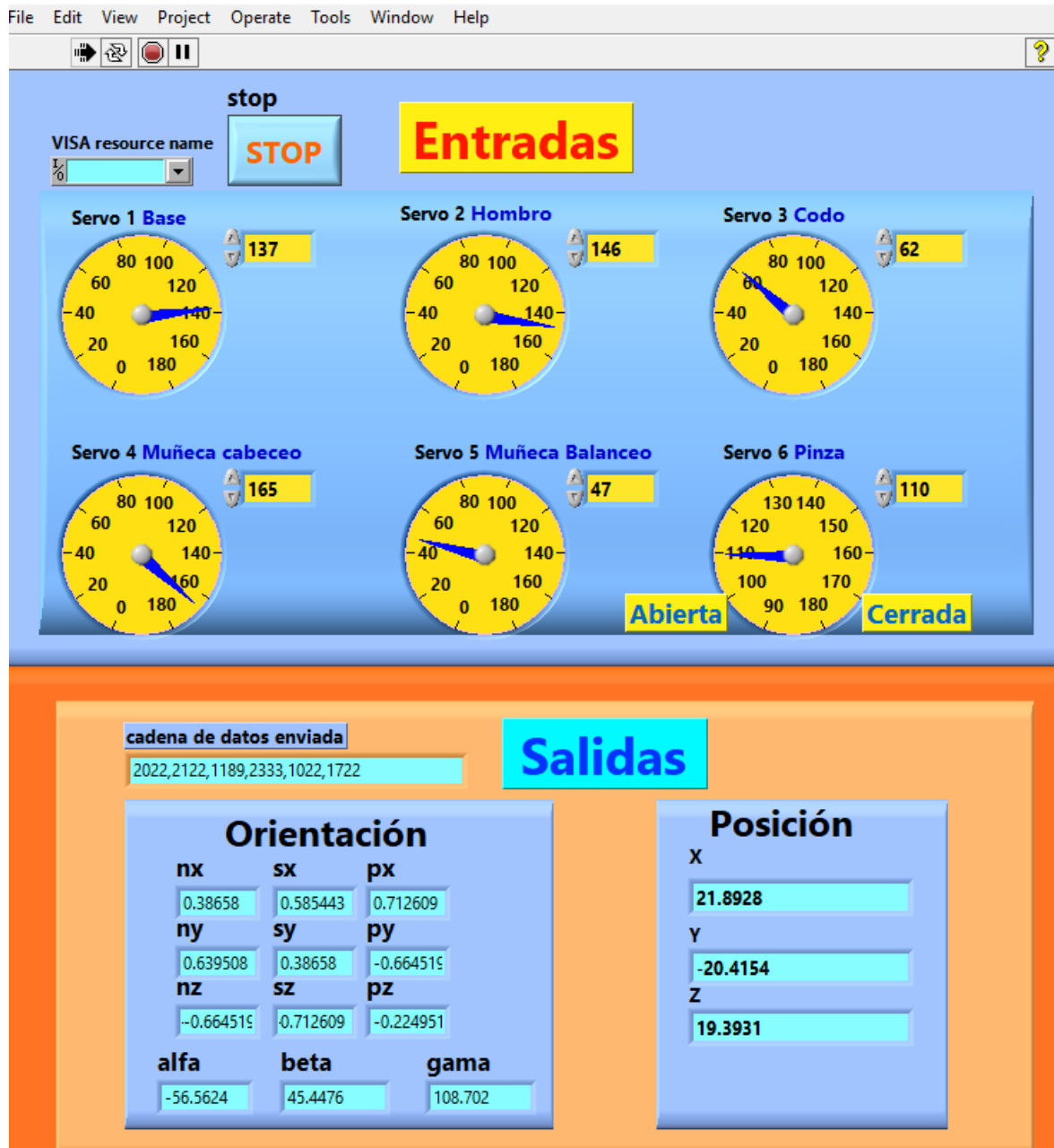
Figura 114 Comprobación con la cinemática directa de la segunda solución mostrada en la figura 113.
