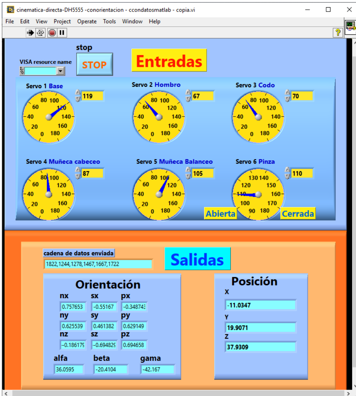
Figura 109 Comprobación con la cinemática directa de la segunda solución mostrada en la figura 108.
