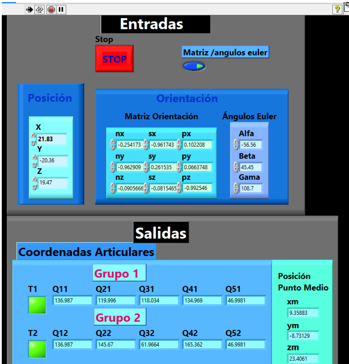
Figura 113 Datos de entrada y salida para la cinemática inversa de la tercera prueba.
