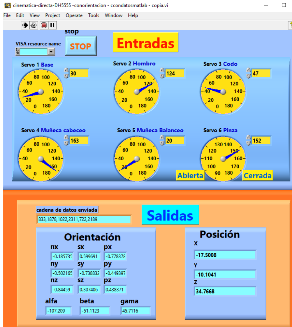
Figura 101 Panel frontal del programa de cinemática directa con los datos ingresados y los obtenidos para la tercera prueba.
