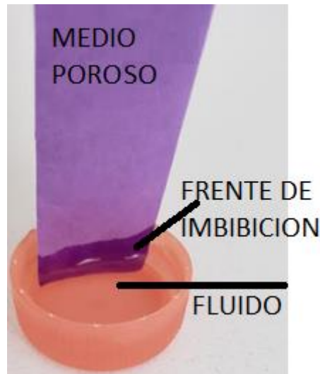
Figura 2.5 proceso de absorción por efectos de la presión capilar
