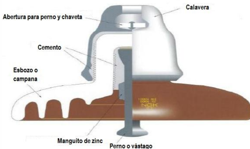
Figura 2.2. Partes de un aislador [NGK, 2007].
