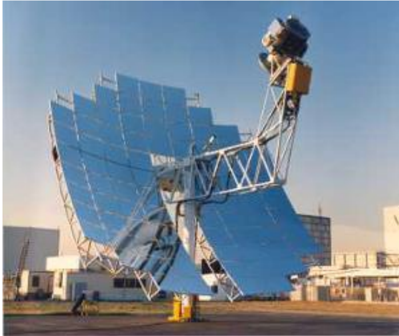
Imagen 3.2 Sistema McDonnell-Douglas rescatado de http://www.solarenergytopics.com/solar/mcdonnell-douglas-stirling-system.html
