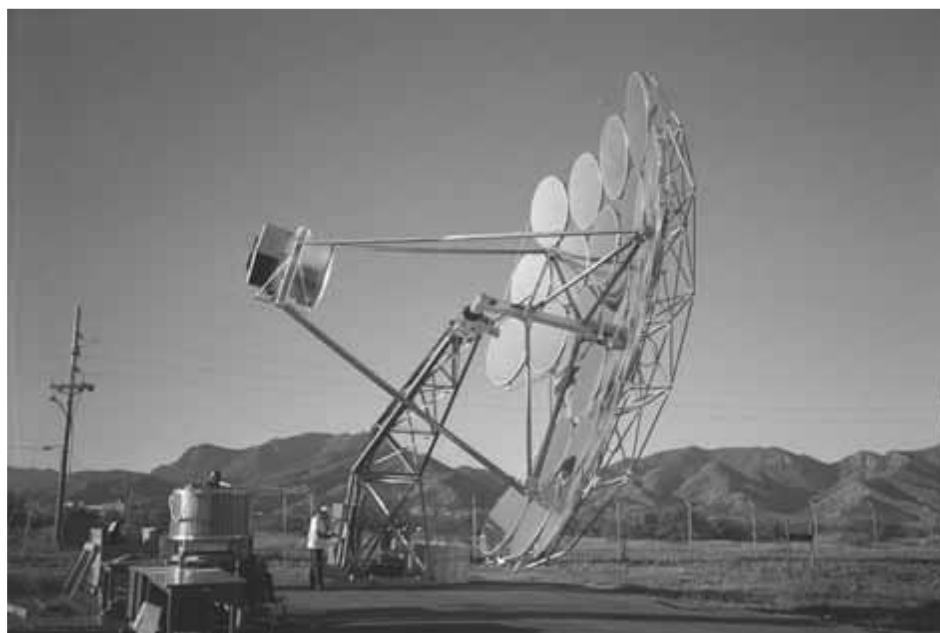
Imagen 3.5 Concentrador Cummins Power Generation CPG-460 con multifacetadas de membranas tensionadas, (obtenido Lovegrove and Staine, 2012, pag 319).
