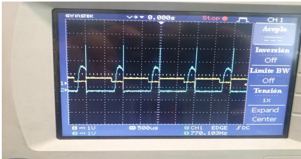
Fig.39 señal de salida de pulso cardiaco
