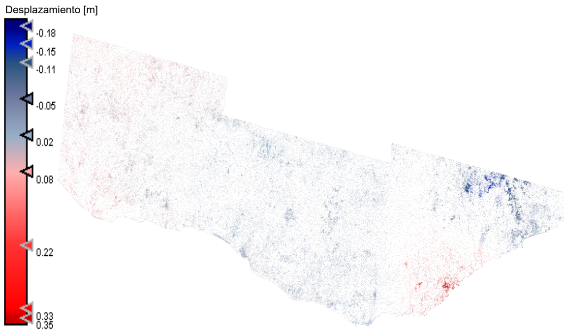
Figura 42. Desplazamiento con coherencia enmascarada. Esta imagen representa el grado de similitud temporal entre las dos adquisiciones SAR, obtenida mediante los procesos finales del flujo de procesamiento, se generó este mapa de coherencia donde los valores (entre 0 y 1) indican la calidad y confiabilidad de la medida interferométrica en cada píxel (5.4 Coherence Mask). Los valores cercanos a 1 representan áreas de alta coherencia (superficies estables), mientras que valores cercanos a 0 indican baja coherencia (zonas con cambios temporales o vegetación). Este mapa de coherencia fue exportado (5.5 Export Image) en formato raster para su análisis cuantitativo. Los valores numéricos mostrados (entre 0.35 y -0.18) corresponden a representaciones específicas de la coherencia procesada, donde los valores negativos indican áreas de muy baja coherencia. Este producto se utilizó para enmascarar las zonas menos confiables del mapa de desplazamiento final, mejorando la calidad interpretativa de los resultados. La aplicación de la máscara de coherencia y el proceso de exportación se detallan en el Anexo A de esta tesis.
