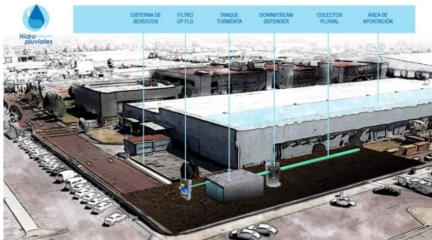
Figura 12. Sistema de captación de agua de lluvia en industria automotriz. Fuente: Soluciones Hidropluviales.
