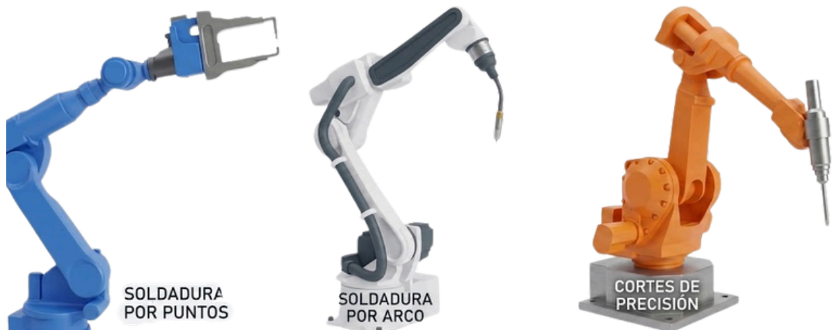
Figura 2.1 Robots seriales con diferentes efectores finales para soldadura
