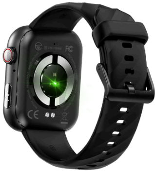
Figura 10.1 Vista posterior de un reloj inteligente, donde se puede apreciar la luz verde que activa el sensor ECG, el cual es usual encontrar en este tipo de dispositivos, para monitorear el ritmo cardíaco del usuario.
