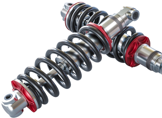
Figura 7.10 Los amortiguadores de automóvil utilizan un resorte, también llamado muelle, y un cilindro de aceite, los cuales generan un amortiguamiento viscoso.
