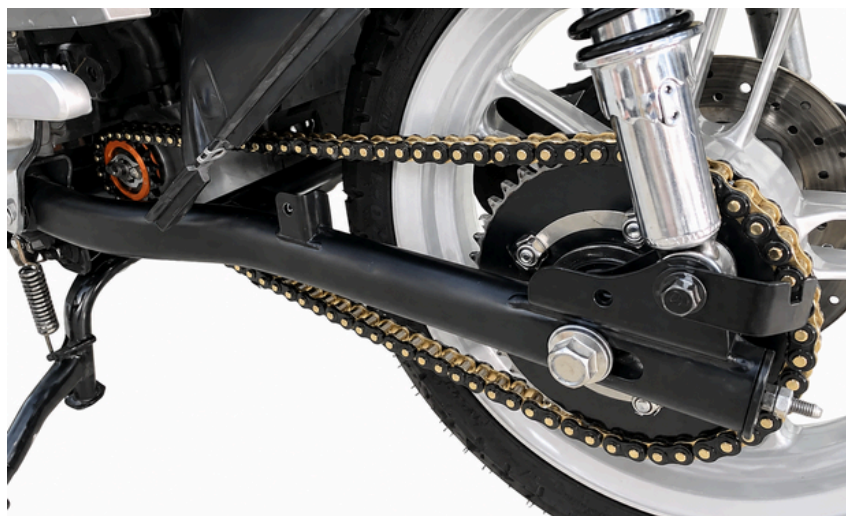
Figura 7.18 Cadena de transmisión en motocicleta
