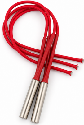
Figura 10.13 Heater cartridge para impresora 3D. El microcontrolador manda una señal para activarlo, sin embargo, se requiere una etapa de potencia (ver sección 5.3) para darle la suficiente corriente para que eleve la temperatura; el microcontrolador no puede hacerlo por sí solo.
