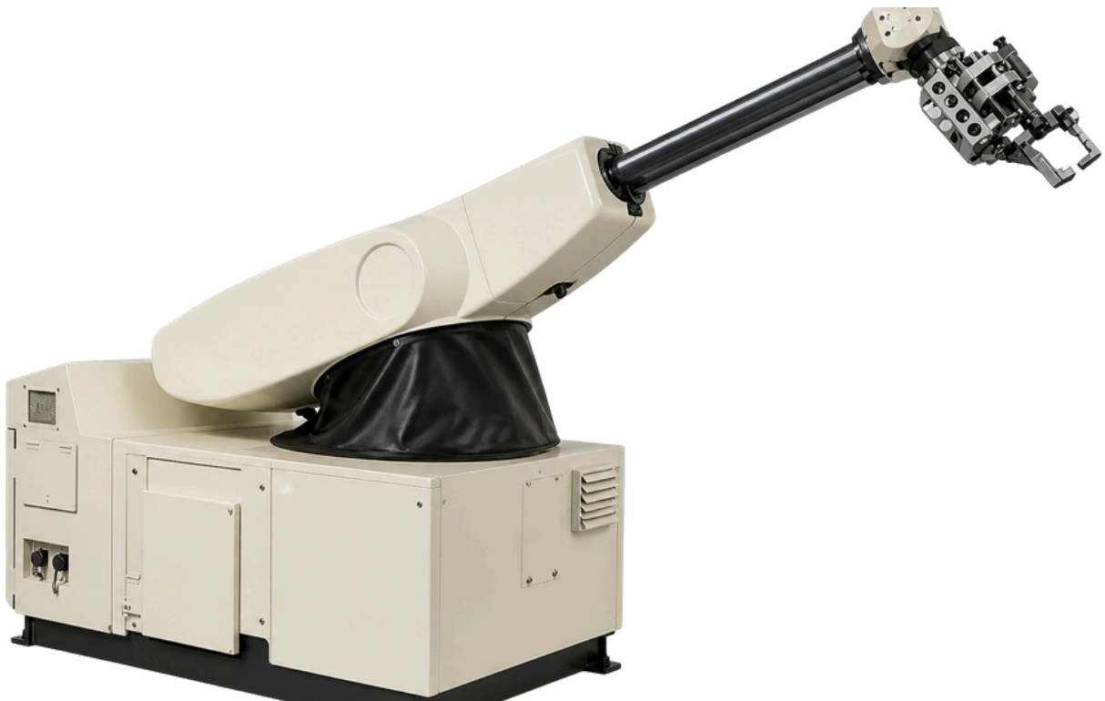
Figura 10.16 El Unimate fue conceptualizado y construido por George Devol, quien lo patentó en 1954. El Unimate era un brazo robótico hidráulico, capaz de realizar tareas repetitivas como la manipulación de piezas fundidas y la soldadura en la industria automotriz. Esta imagen es una representación de su forma y componentes.
