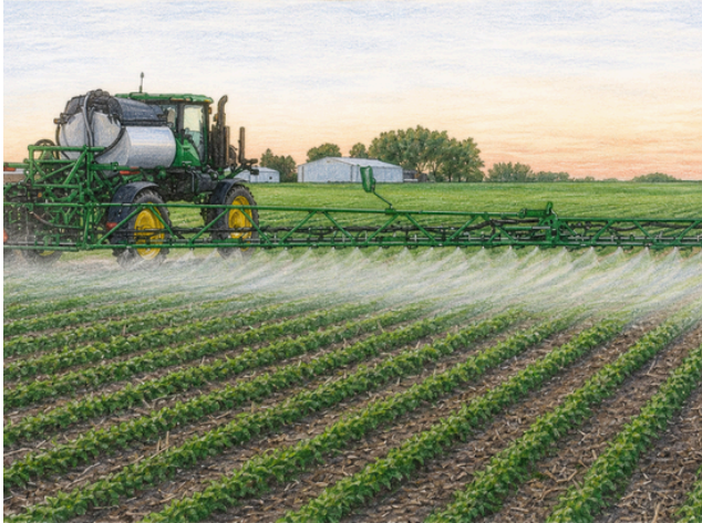
Figura 10.22 Tecnología Blue River's See & Spray implementada en un tractor para desmalezamiento químico. Detecta el tipo de maleza y aplica la cantidad exacta de químico. Dibujo representativo.
