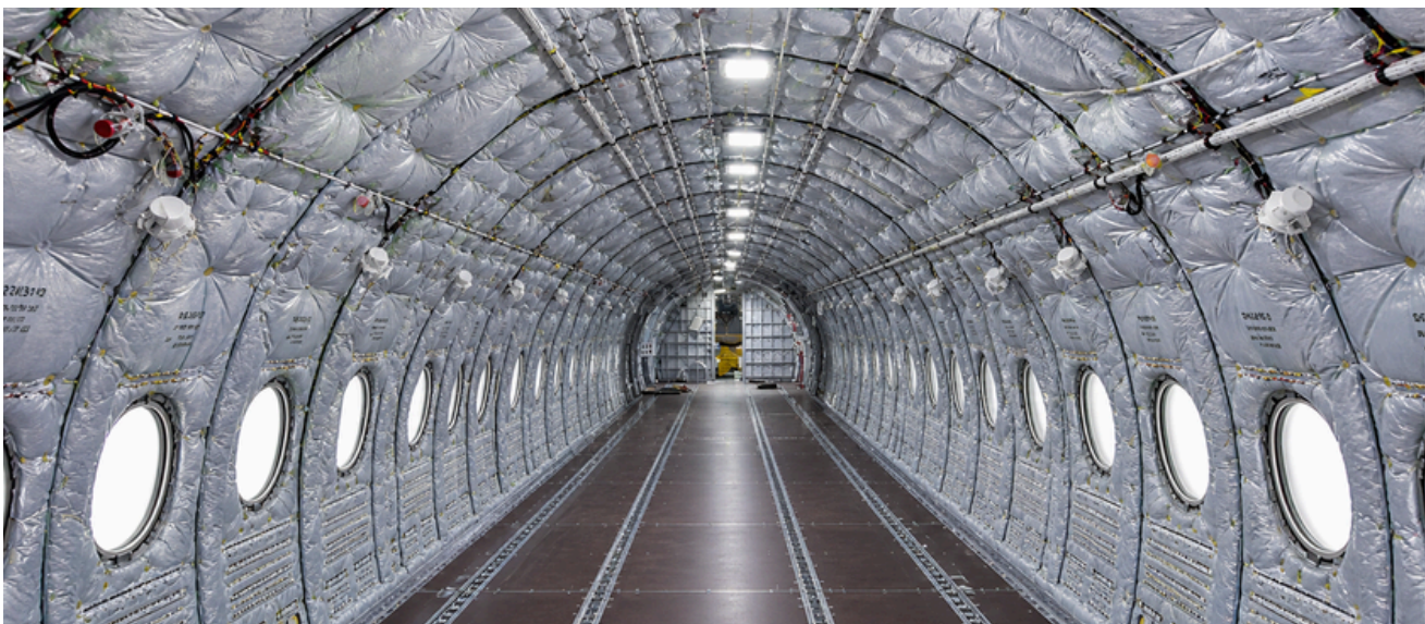
Figura 11.2 Material aislante en aviones para mantener climatizada la cabina con menor uso de energía de los motores
