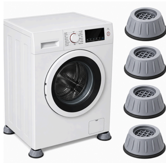
Figura 7.11 Muchas máquinas utilizan el amortiguamiento material para evitar daños en los equipos durante el trabajo; por ejemplo, en la lavadora, mientras realiza los ciclos de trabajo unas almohadillas de caucho absorben la energía de la vibración.
