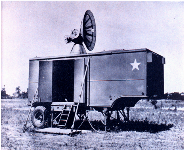
Figura 10.7 Se muestra una fotografía del radar SCD-548 desarrollado por el Laboratorio de Radiación del MIT (Instituto Tecnológico de Massachusetts, por sus siglas en inglés) durante la Segunda Guerra Mundial. Este sistema usaba servomotores para seguir blancos automáticamente. Nota. Exterior view of radio set SCR-584, de Wikimedia Commons (s.f.), dominio público.
