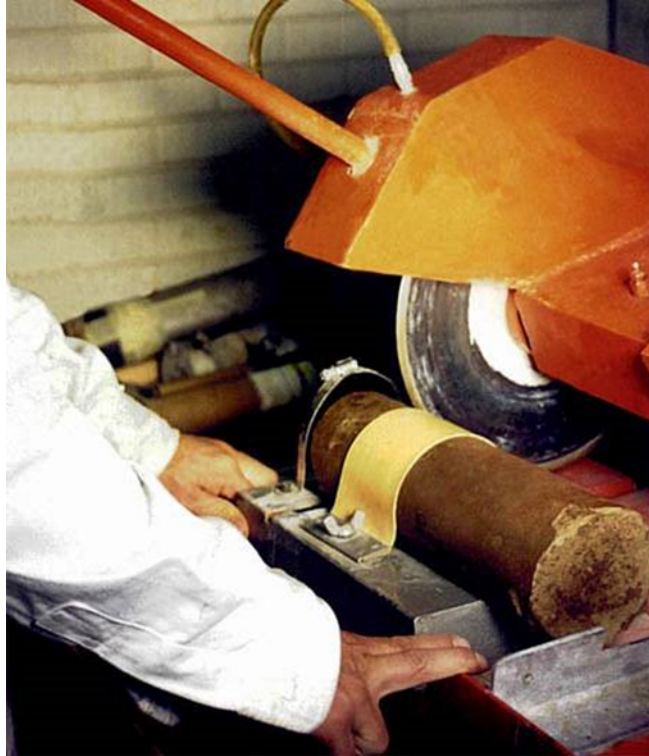
Fig. 3.2: Dimensionamiento de las muestras para su manejo correcto en el equipo de medición.
