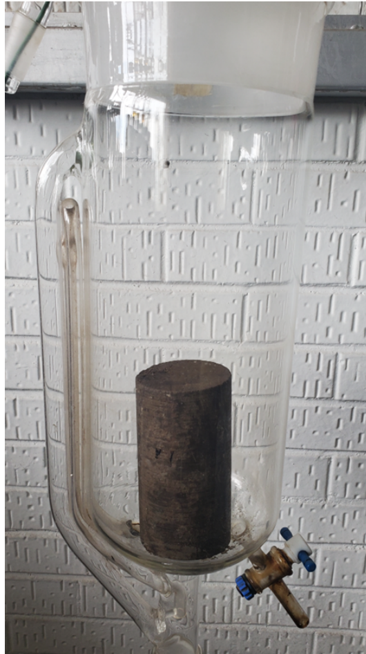
Fig. 3.3: Muestra en proceso de destilación cíclica en el equipo de cristal Dean-Stark.
