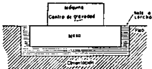
Fig. 42 ESQUEMA SEÑALANDO LA MASA AÑADIDA Y LA UTILIZACION DE UN AISLADOR COMO HULE O CORCHO (Ref. 8)
