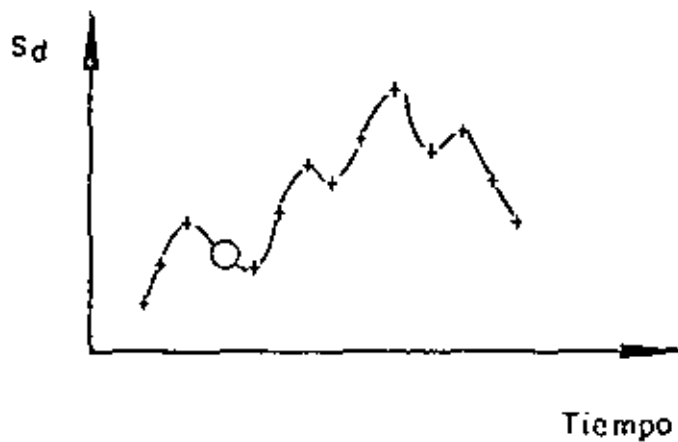
e) Espectro de respuesta para un amortiguamiento D_1
