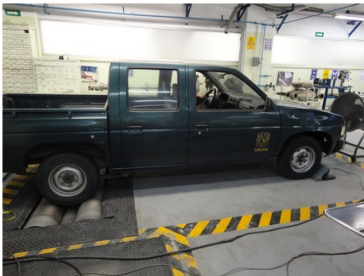
Foto 24. Dinamómetro de chasis y camioneta estaquitas.
