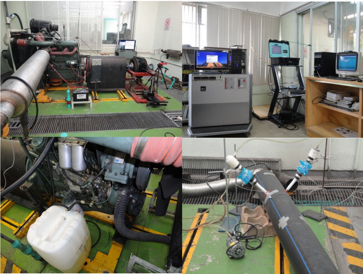
Fotos 3, 4, 5 y 6. Pruebas en dinamómetro de banco.
