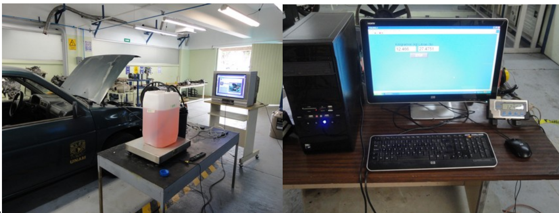
Fotos 26 y 27. Medición de consumo de mezcla E6.
