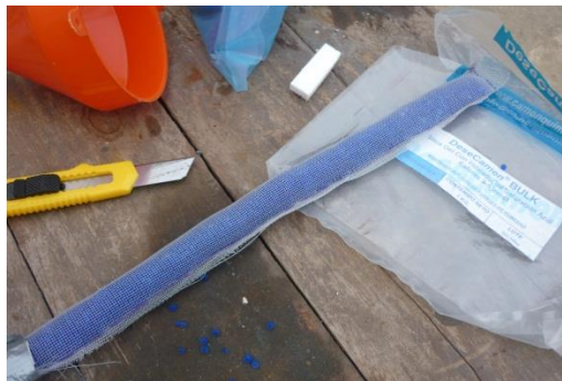
Figura 30a. Sílica gel dentro de una malla capaz de permitir la transferencia del vapor de agua del aire hacia la sílica gel
