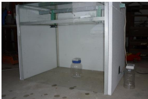
Figura 36. Los sensores Hobo U12 dentro y fuera del prototipo experimental para hacer las mediciones de temperatura y humedad relativa horarias
