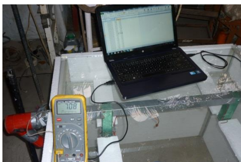
Figura 37. Multímetro Fluke, midiendo temperatura y humedad relativa a la entrada del ducto en el proceso de desorción.
