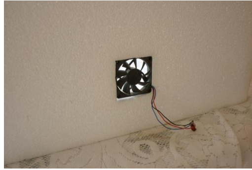
Figura 31a. Ventilador axial instalado en una pared lateral del prototipo experimental para simular la ventilación hacia el interior del espacio a deshumidificar.
