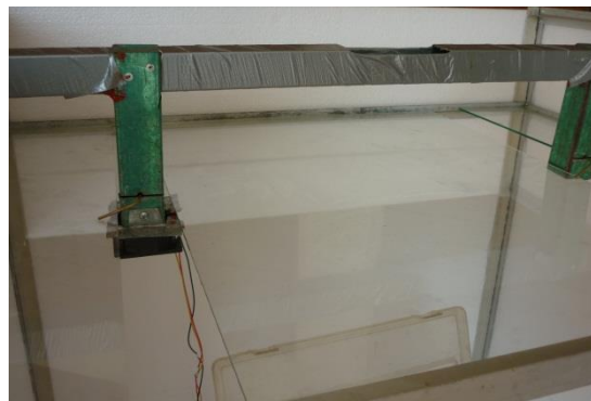
Figura 31b. Ventilador axial instalado en la tubería de distribución para crear un flujo de aire que pase sobre la placa desecante y recircular el aire en la habitación.
