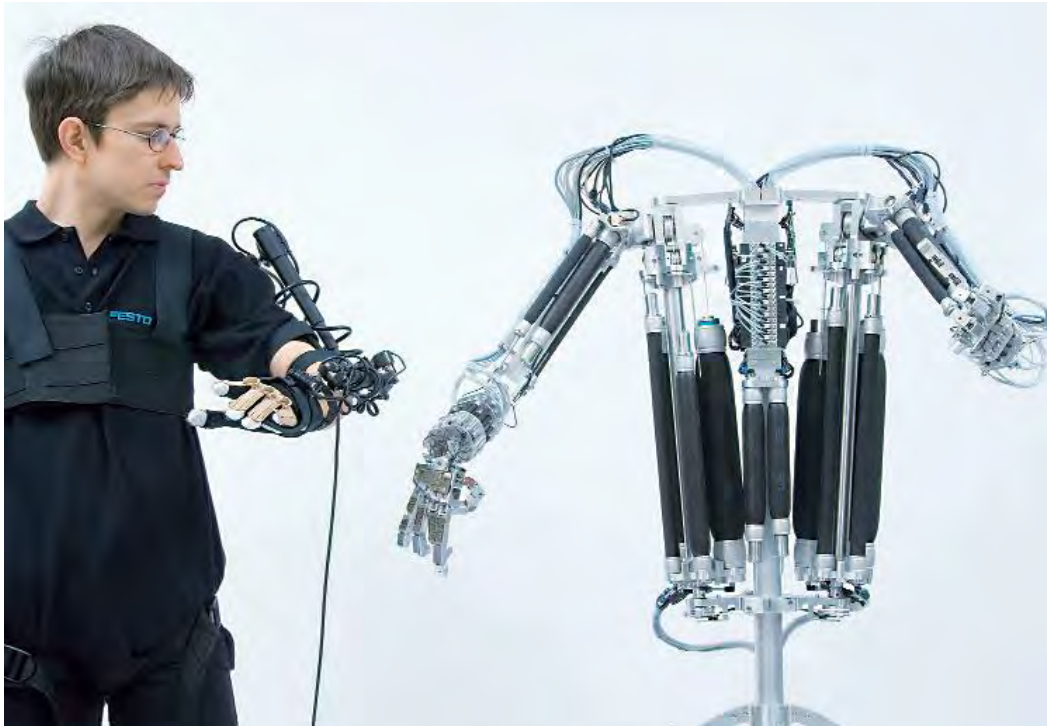
Figura 20. El robot humanoide capaz de sintetizar los movimientos de alrededor de 1° de precisión.
