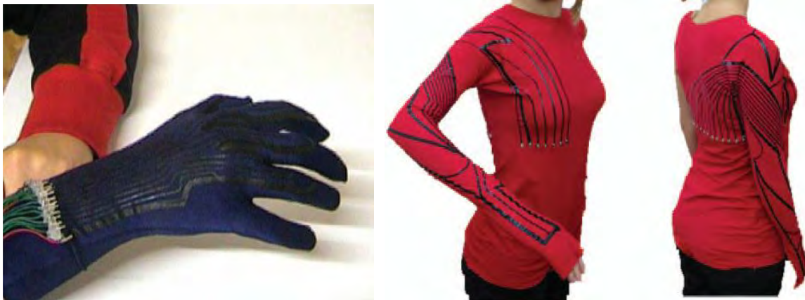
Figura 12 Guante y prenda con compuesto de elastómero piezoeléctrico para seguimiento de movimiento.
