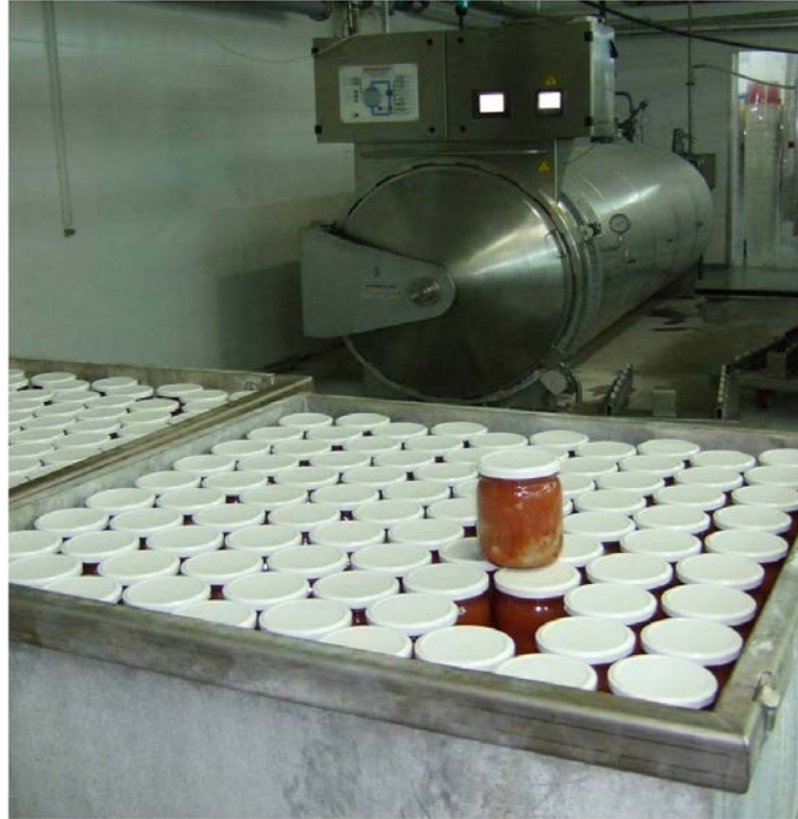
Imagen 1.1.- Canastillas para envase de vidrio en una autoclave estática.
