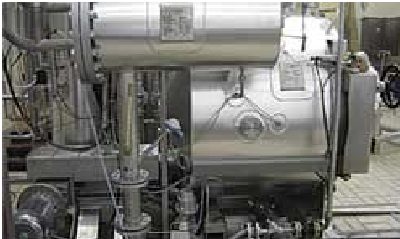
Figura 4.5.- Vista frontal de una autoclave equipada con un mecanismo agitador.
