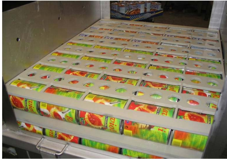
Imagen 1.3.- Canastilla para envase de metal en una autoclave con un mecanismo agitador.
