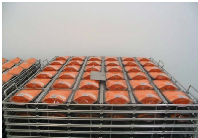
Imagen 1.5.- Canastilla para envase de plástico en una autoclave con un mecanismo agitador.
