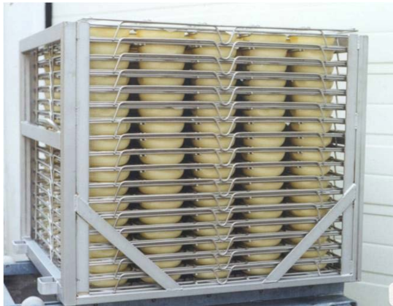
Imagen 1.4.- Canastilla para envase de plástico en una autoclave estática.
