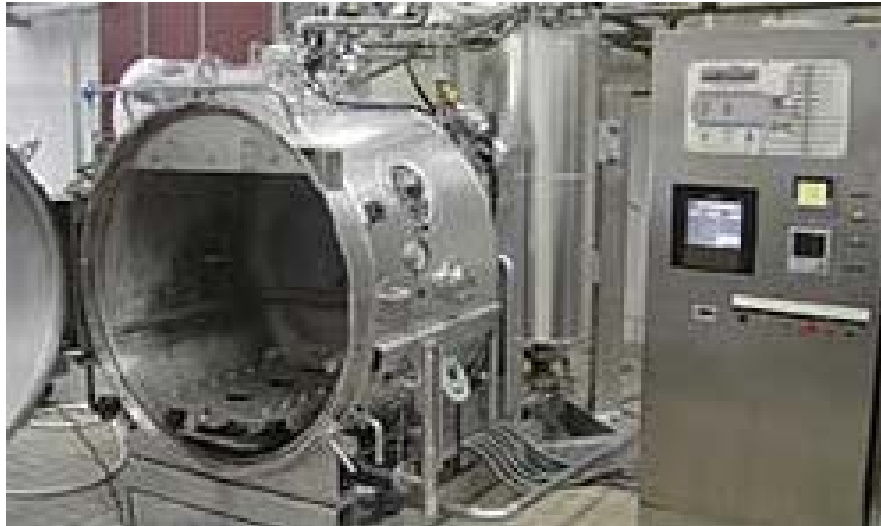
Figura 4.5.- Vista frontal de una autoclave equipada con un mecanismo agitador.
