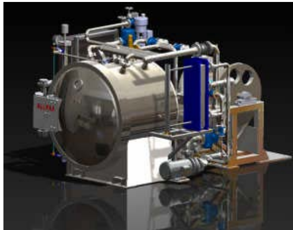
Imagen 4.2.- Modelo CAD de una autoclave equipada con el mecanismo para el proceso Shaka.
