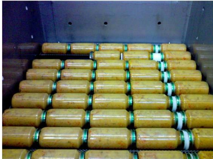
Imagen 1.2.- Canastilla para envase de vidrio en una autoclave con un mecanismo agitador.
