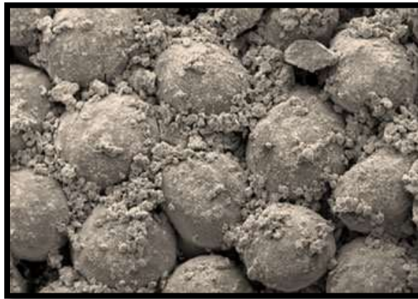
Figura. 2.3- Fotografía de microscopio electrónico de una formación arenosa dañada.
