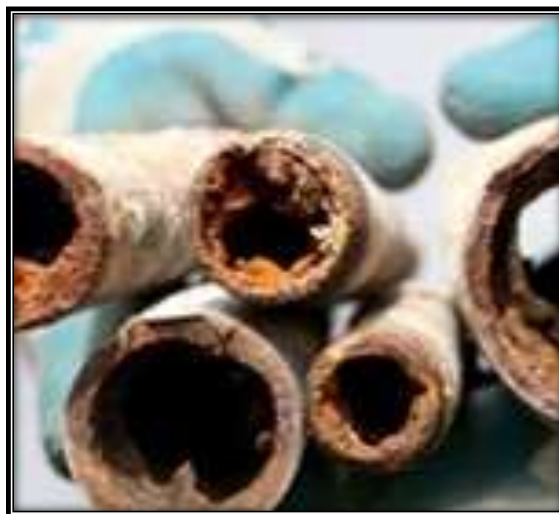
Figura 3.2.- Tubería con depositación de orgánicos.
