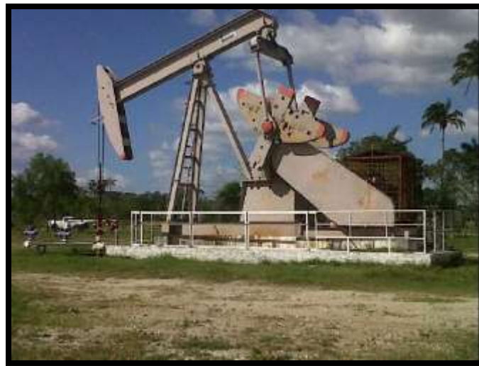
Figura 5.8- Pozo Samaria con bombeo mecánico.
