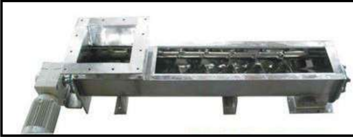
Figura 4.22- Sistema de adición de aditivos tipo tornillo.
