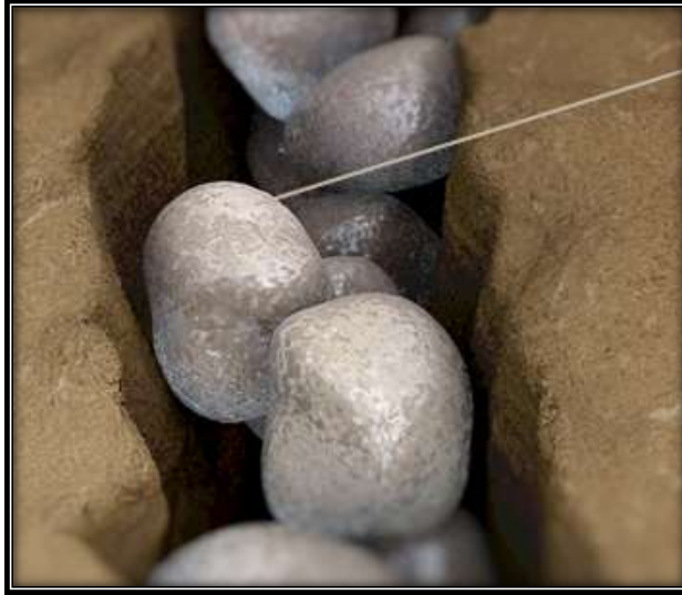
Figura 4.4.- Modelo de apuntalantes en una fractura.
