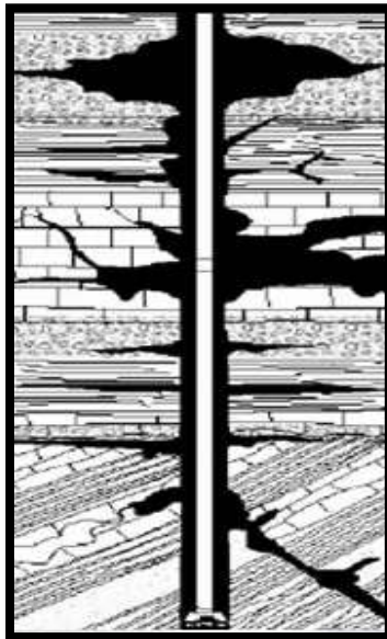
Figura 4.2.- Ilustración de un fracturamiento hidráulico con ácido.
