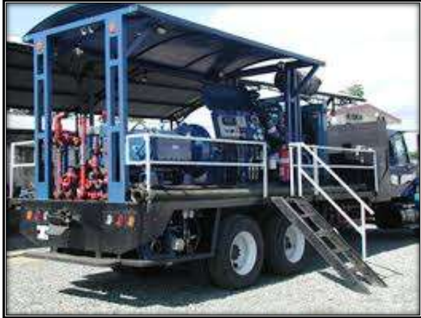
Figura 4.26- Camión e bombeo.
