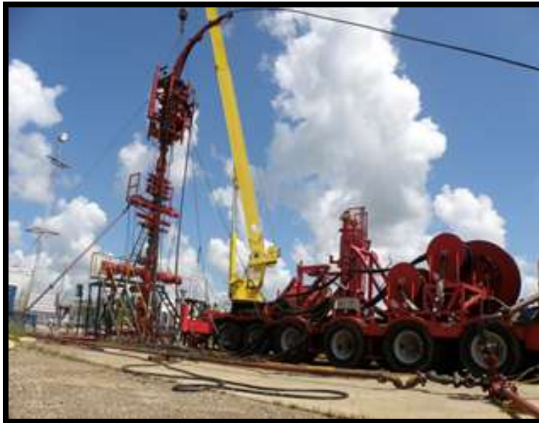
Figura 3.6.- Pozo sometido a estimulación matricial con TF.
