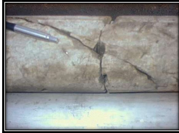
Figura 1.7 – Núcleo fracturado del pozo Artesa 22
