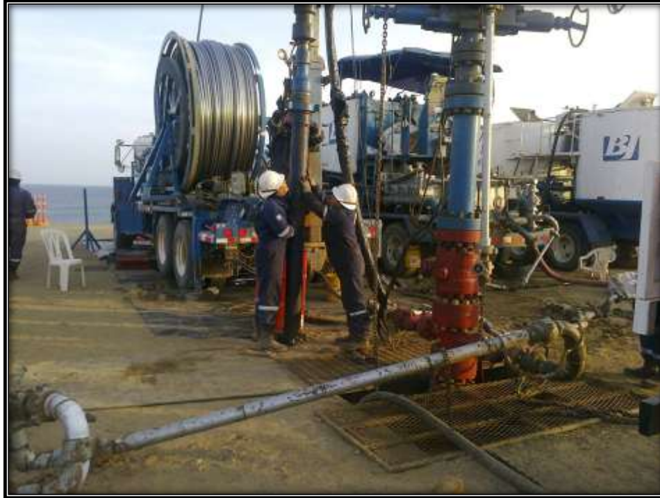
Figura 4.3- Proceso de fracturamiento con gas y tubería flexible.
