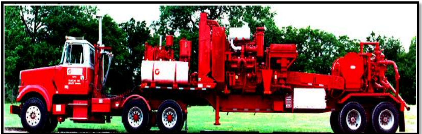
Figura 4.27- Camión de bombeo HT-400.
