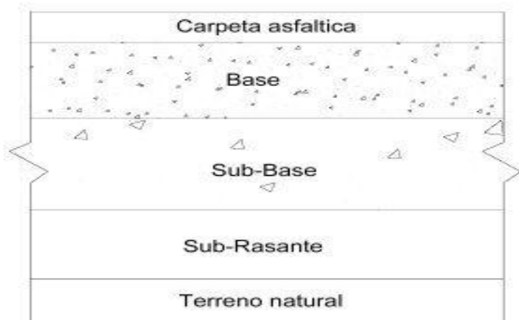
Fig.3.8.b.20 Sección de pavimento flexible.
