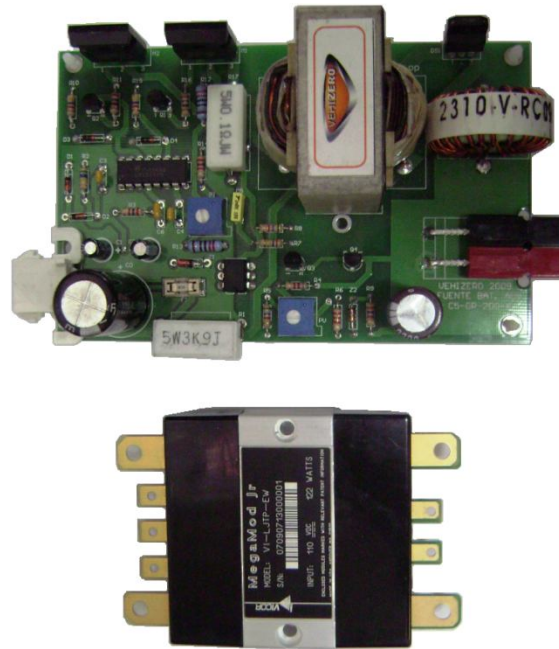
Figura 54.- Tarjeta del prototipo fabricado y la fuente VI-LJTP-EW de Vicor Power.
