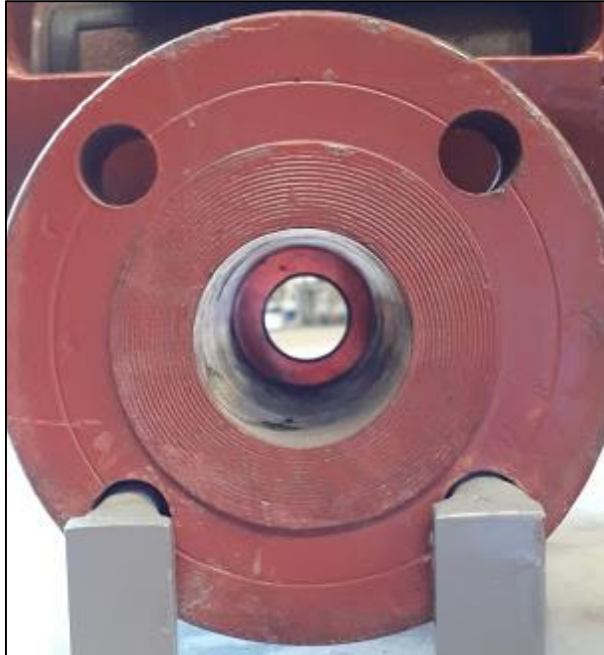
Figura V.1. Placa de orificio concéntrica instalada en tubería. (Guzmán, L., 2019) 2
