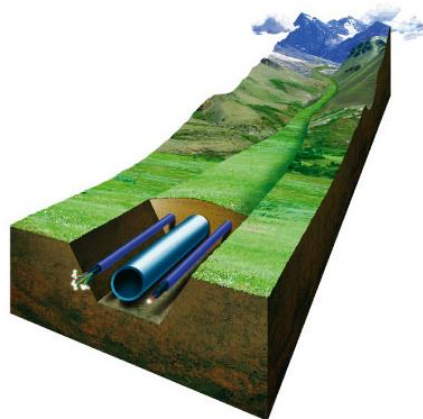
Figura 1.1. Ilustración de una tubería de transporte por flujo, tubería en el centro, instalada bajo el nivel del suelo.
