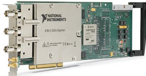
Figura A.2 Tarjeta PCI-5152 (Osciloscopio).
