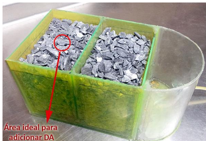
Figura 3.1. Celda de tratamiento empacada con roca filita (Fuente: Laurel, 2016)
