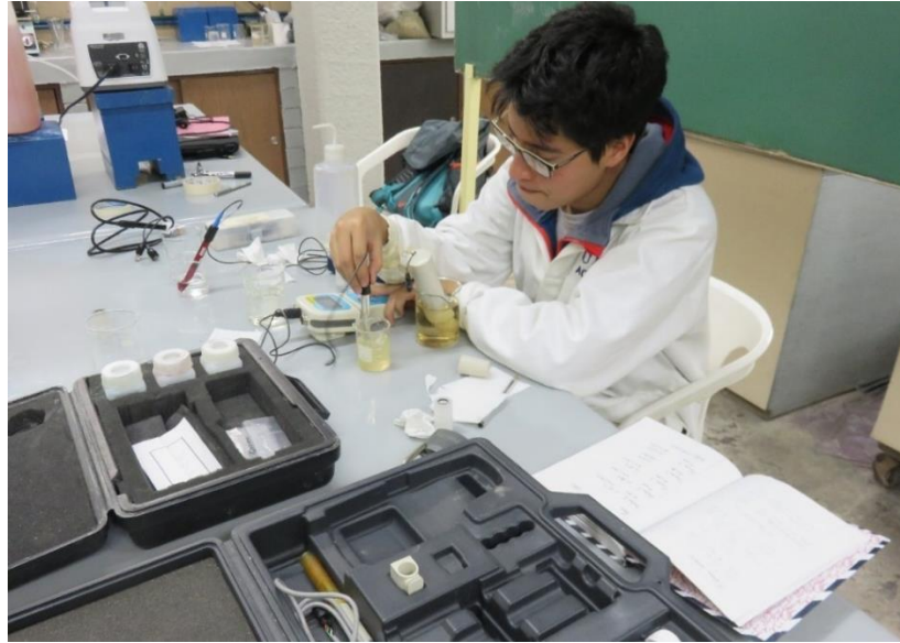
Figura 5.4. Toma de parámetros como: pH, conductividad eléctrica, temperatura y potencial óxido-reducción, de las muestras obtenidas de los diferentes derrames de la prueba.
