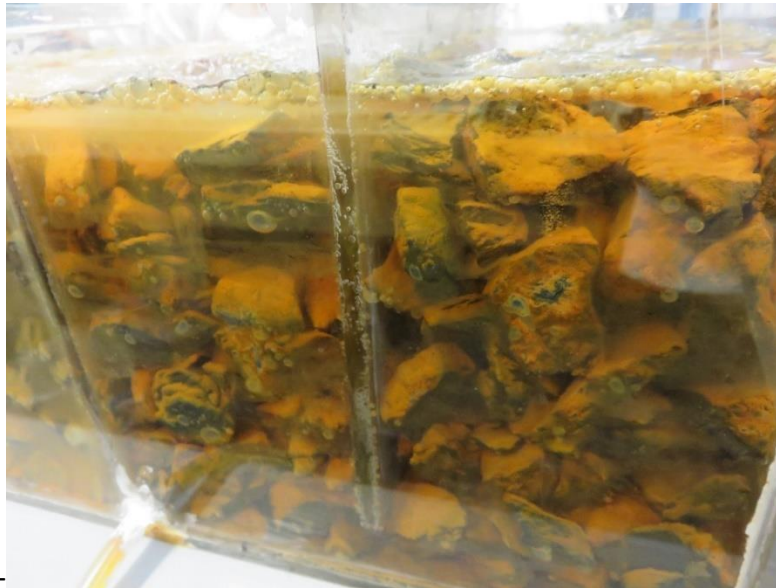
Figura 6.2. Módulo 1 de la celda al finalizar la prueba 1. Se observa un sedimento de color rojizo marrón como resultado de la precipitación de los metales por el aumento del pH.
