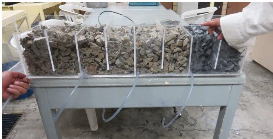
Figura 5.2. Vista lateral de la celda construida y empacada para la prueba 1 y 2.
