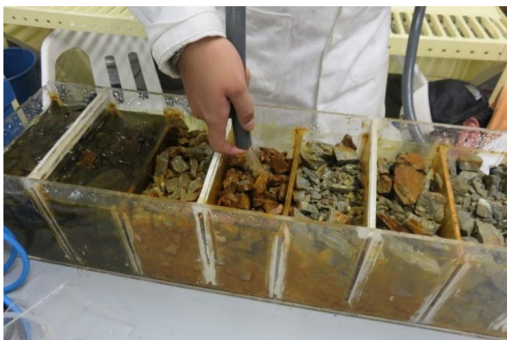
Figura 5.15. Lavado de roca, dentro de la misma celda, para remover el exceso de sedimentos y que éstos sean expulsados por el desagüe del fondo
