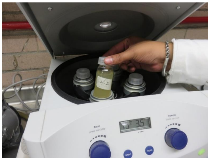
Figura 5.13. Colocación de los viales para su centrifugado con solución recogida de los derrames de los módulos 1, 2, 3 y 4.
