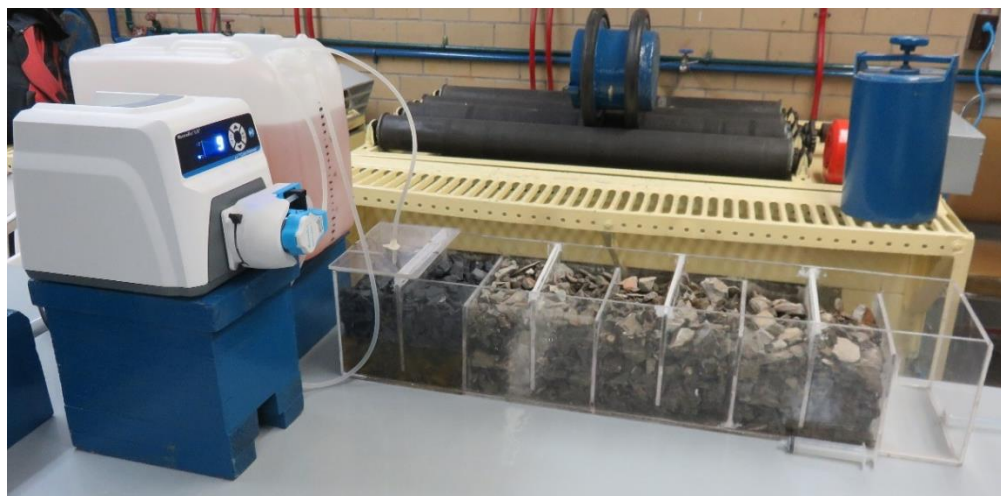
Figura 5.6. Prueba 1 en funcionamiento con el módulo 1 a la mitad de su capacidad, aproximadamente.
