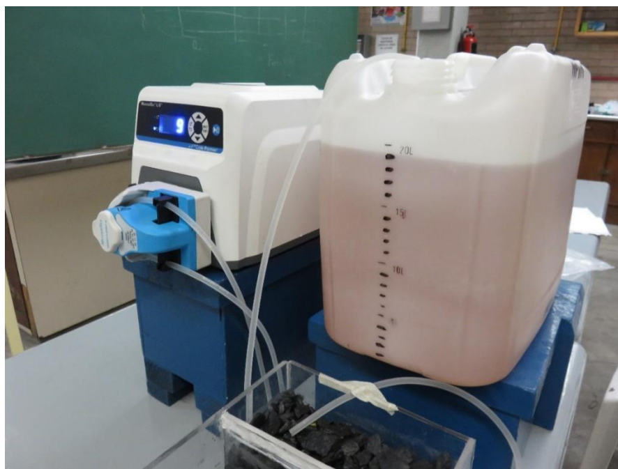
Figura 5.3. Garrafa de 20 litros de capacidad y bomba peristáltica usada a 9 rpm.
