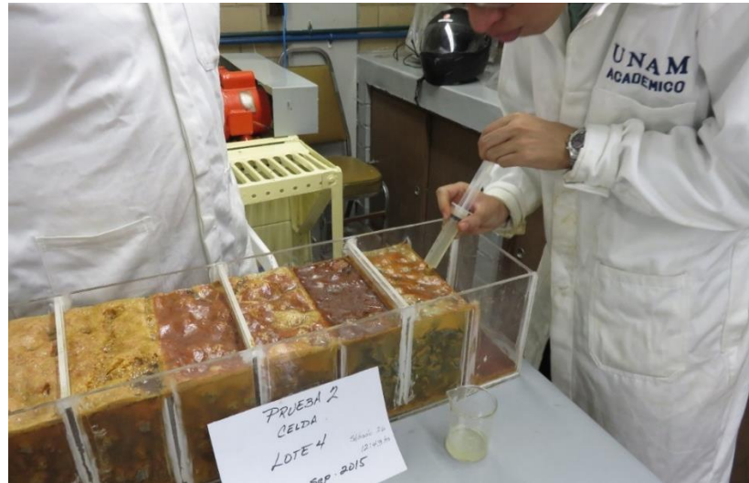
Figura 5.8. Toma de muestra de derrame final de 60 ml del lote 4 de la prueba 2
