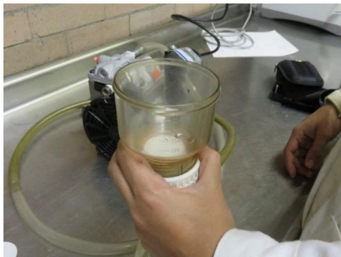
Figura 5.14. Filtrado de cada muestra con ayuda de una bomba de succión, un embudo de filtrado y un matraz.
